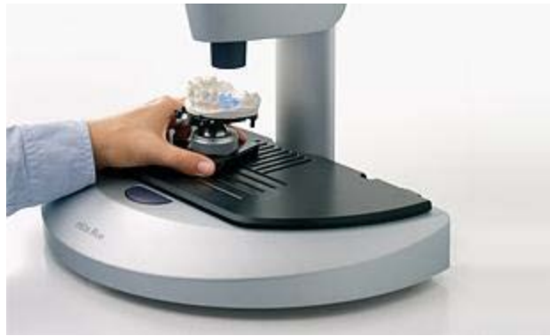
Resim 1: Ağız dışı tarayıcı ile model üzerinden tarama yapılması.
