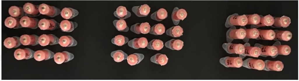
Resim 3.10 Braketlere ligatüre edilmiş 0.021"x0.025"lik çelik ark telleri ve hazırlanan akril bloklar
