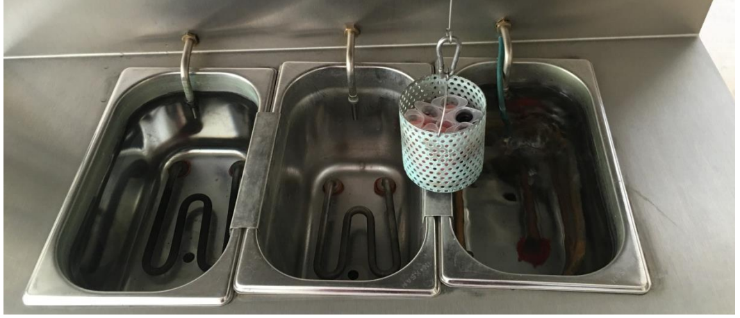
Resim 3.11 5°C ile 55°C sıcaklıktaki su banyolarında gerçekleştirilen termal stres uygulaması
