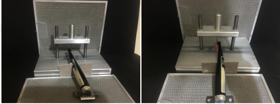
Resim 3.9 Akril blokların düzenekte belirlenen alan içerisine yerleştirilmesi ve ışık cihazının ucu belirlenen referans noktasında 45 derecelik açı ile mezialden ve distalden olacak şekilde ışınlama işleminin uygulanması
