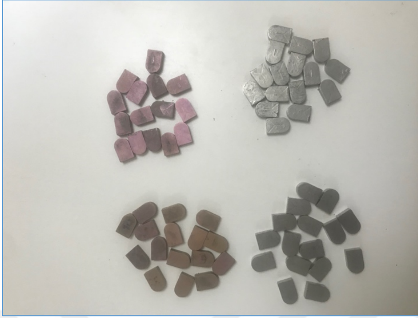
Şekil.17: Milling Yöntemiyle Elde Edilen Anodize Olan ve Olmayan Bloklar
