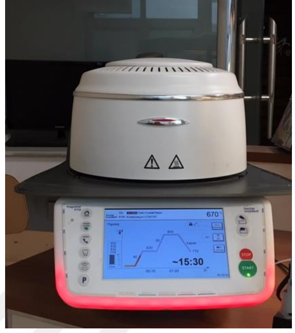
Resim 9-10: Örneklerin seramik fırınında (z.B. Programat P710 ivoclar) kristalizasyonu
