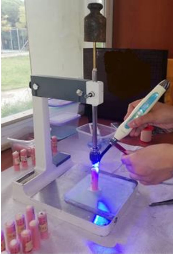
Resim 17-18: Tutucu fiksator yardımı ile sabit kuvvet altında seramik örneklerin yapıştırılıp ışınlanması
