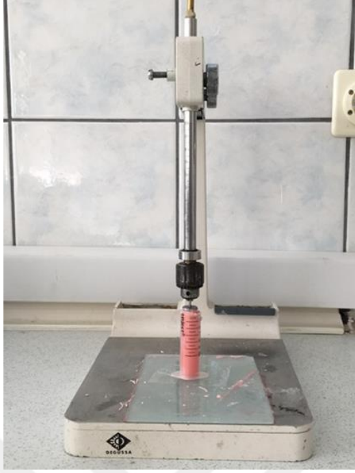
Resim 6: Tutucu ile sabitlenen dişlerin fiksator yardımı ile akriliğe gömülmesi
