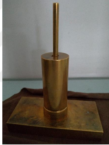
Şekil 2: Shark fin test cihazında ölçü maddesinin içinde yükseldiği 1 mm'lik yarıık
