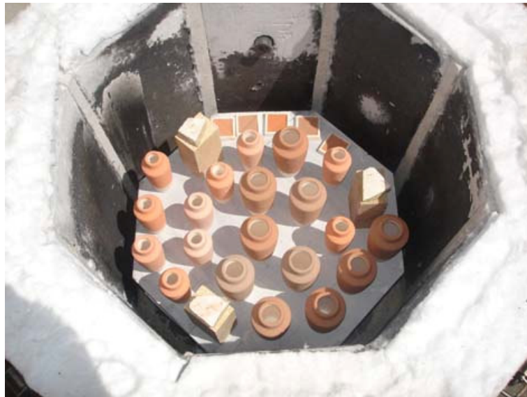
Resim 60. Fırın İçine Yerleştirilmiş Üç Boyutlu Formlar
