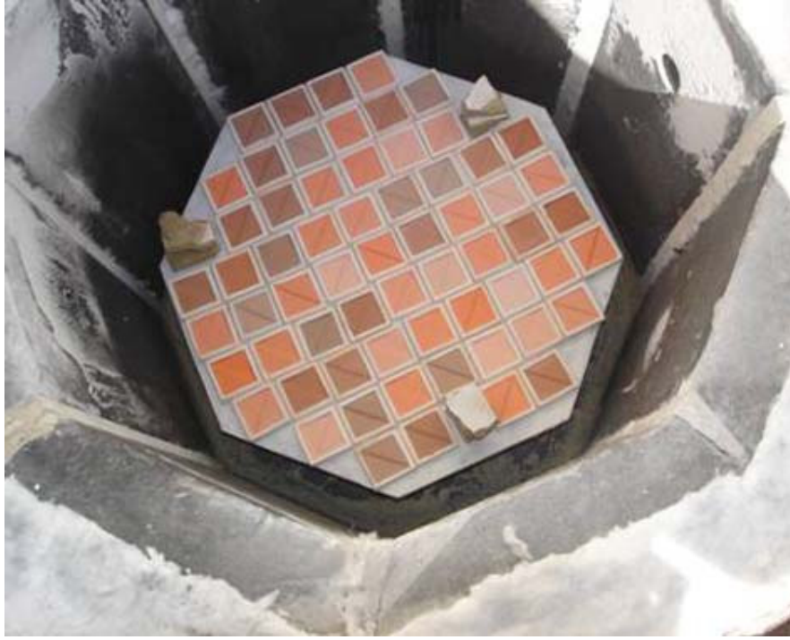
Resim 59. Fırın İçine Yerleştirilmiş Sır Plakaları
