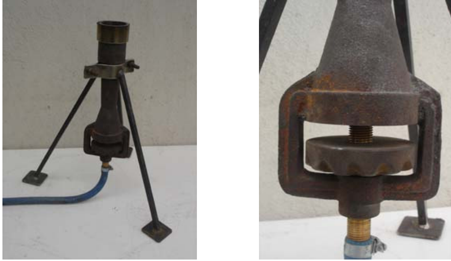
Resim 57. Gazlı Fırında Kullanılan Brülör ve Hava Kontrol Detayı
