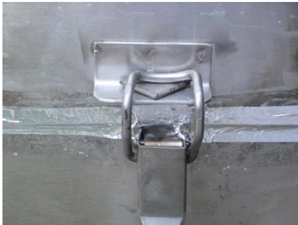
Resim 64. Fırının Hava Giriş Çıkışlarının Kapatılması Detayı
