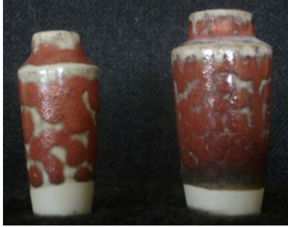
Resim 78. 1200°C Sıcaklıkta Gelişebilen Bakır Kırmızısı Beşinci İndirgen Sır Pişirimi Üç Boyutlu Form Uygulamaları
