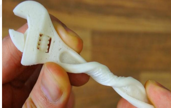
Görsel 15. TPE (termoplastik Elastomer) Filament ( www.google.com Erişim tarihi: 05.04.2019)
