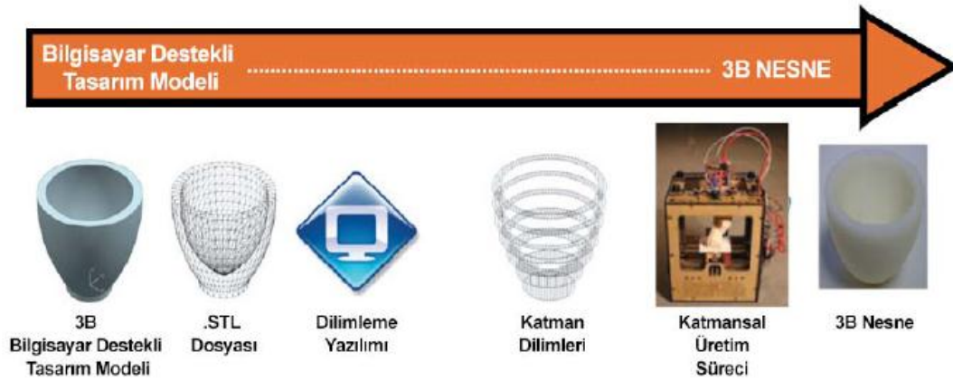
Görsel 6. Üç boyutlu modelin üretim süreci (Campbell, Williams, Ivanova ve Garrett, 2011, s.3; Akt: Kuzu Demir ve diğerleri, 2016; Karaduman, 2017a)
