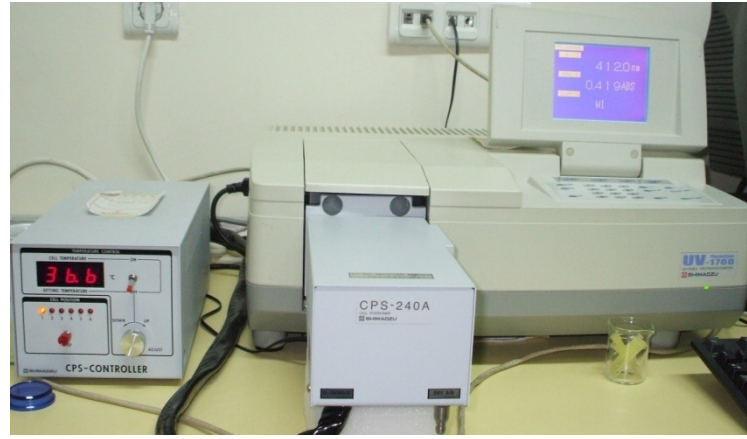
Şekil 7. Antioksidan Aktivite Çalışmalarında Kullanılan UV-VIS Spektrofotometre
