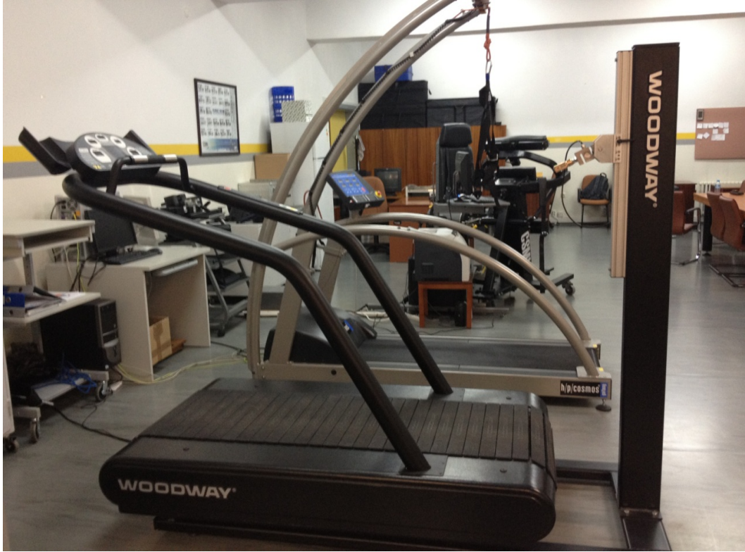
Şekil 14: Kuvvet ölçebilen Motorsuz Koşu Bandı
