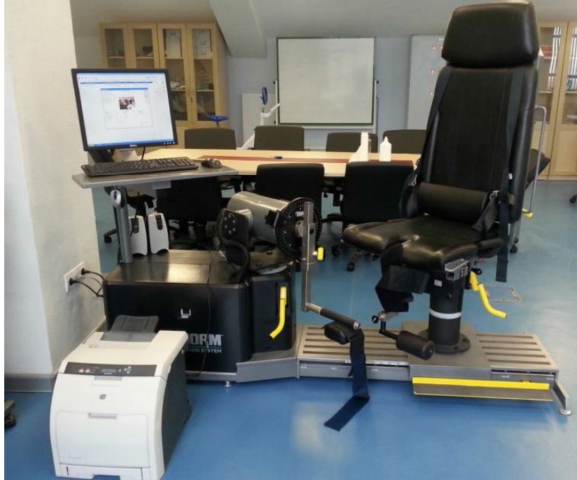
Şekil 22. İzokinetik kuvvet ölçüm cihazı
