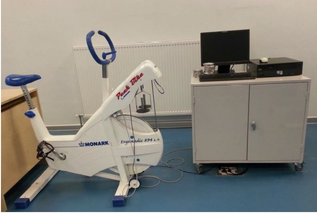
Şekil 23. Anaerobik güç ve kapasite ölçüm sistemi
