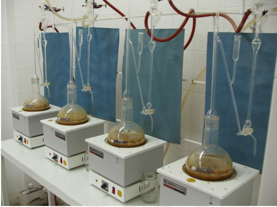
Şekil 8. Clevenger Aparentleri ve Uçucu Yağ Eldesi İşlemi
