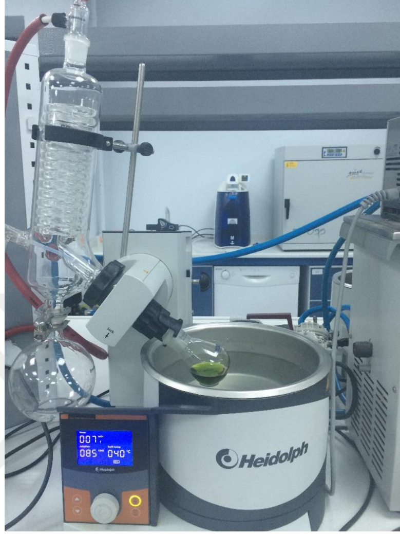
Görsel 2.5. Ekstrelerin Rotavapor'da Çözücüden Uzaklaştırılması
