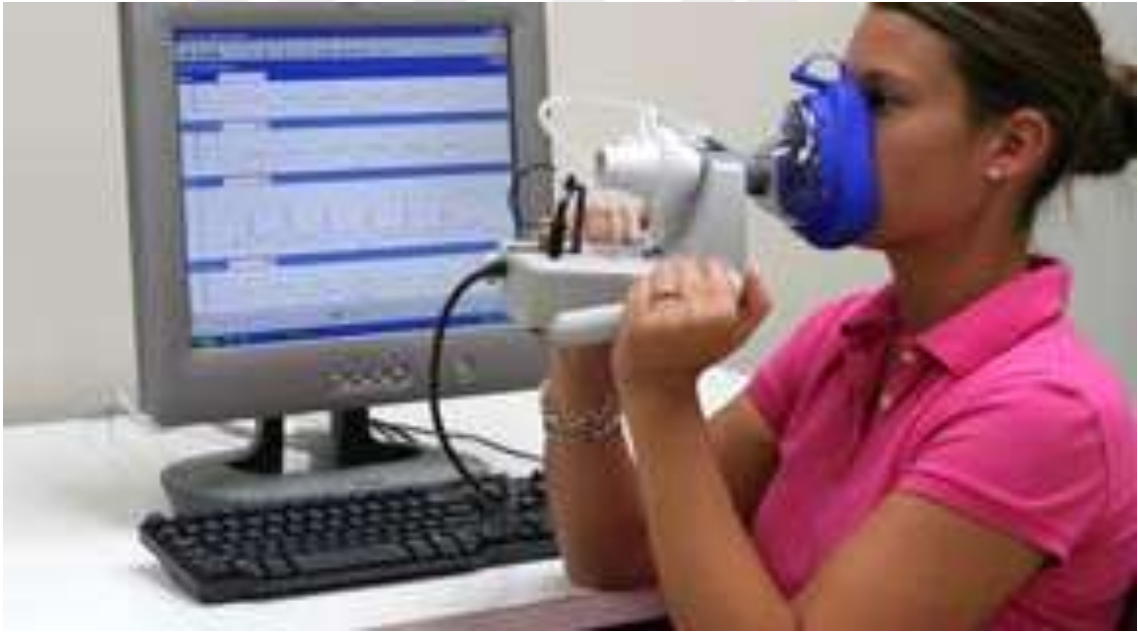
Görsel 2.1. Fonotuar Aerodinamik Sistem 6600 (PAS) Kaynak: http-1
