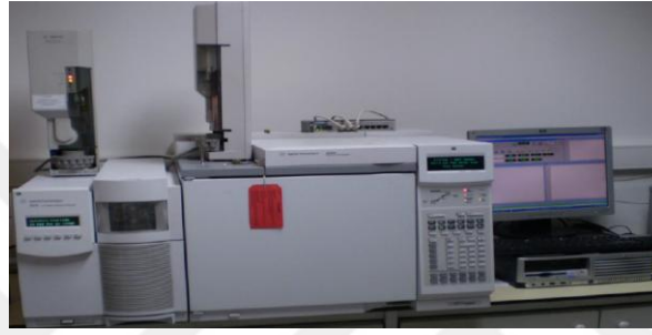
Görsel 3.7. Farmakognosi Bölümü Agilent 5975 GC/MSD Sistemi (1.7.2016)
