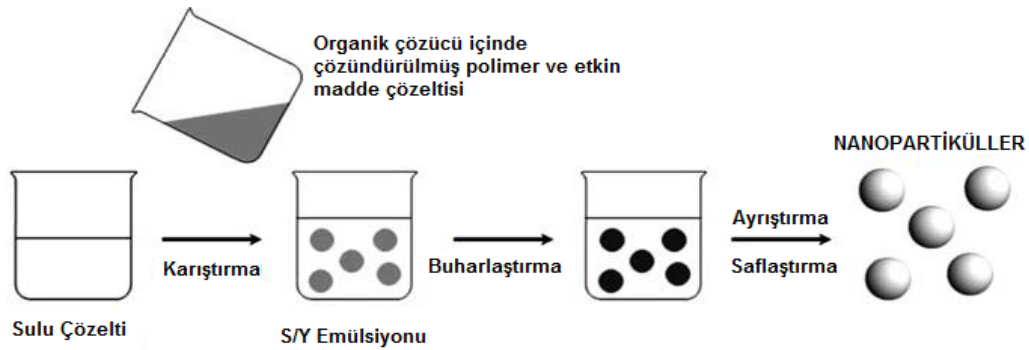
Şekil 2.6. Çözücü Buharlaştırma Yöntemi ile PNP Üretimi
