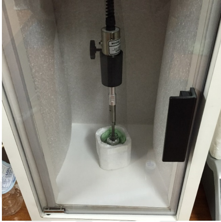
Görsel 4.3. Prob Sonikasyon Cihazı ile Formülasyon Hazırlanması
