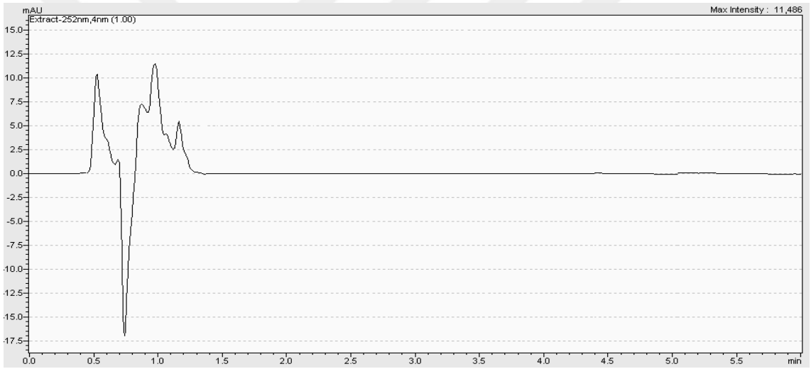
Şekil 5.15. 2-Propanol'e ait YBSK Kromatogramı
