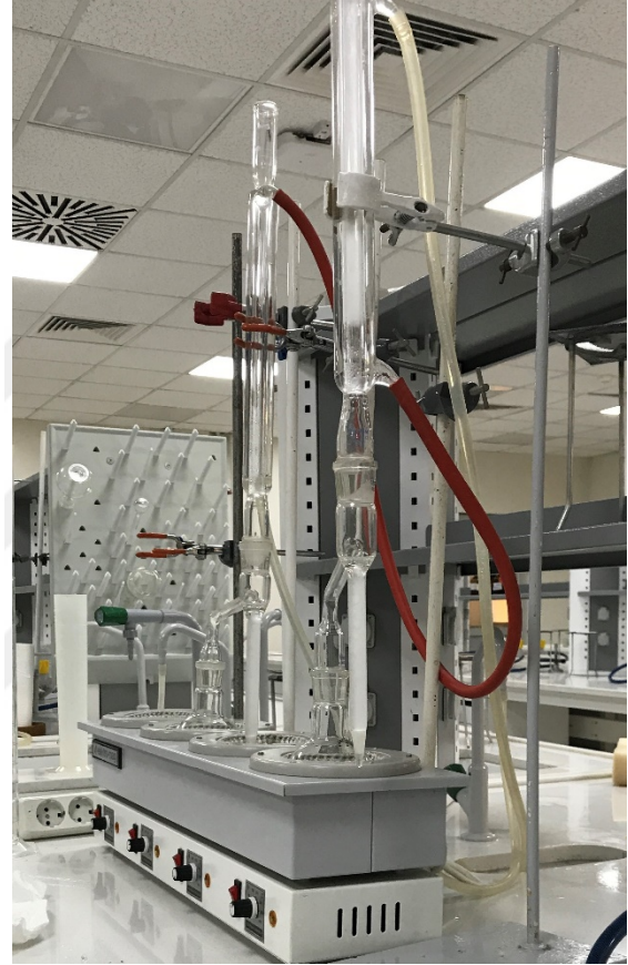
Şekil 3.1. Avrupa Farmakopesi'nde tanımlanan volumetrik su miktar tayini apareyi (Ph. Eur., 2013b).
