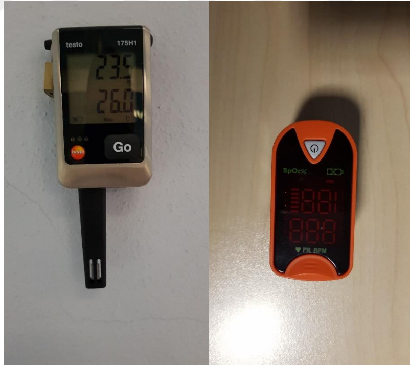
Görsel 3.11. Sıcaklık, nem ve oksijen saturasyonu cihazları
