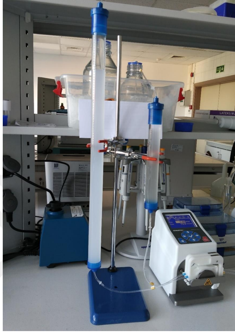
Şekil 4.1. Sephadex G-100 jel filtrasyon kolonu (solda) ve DEAE-Sephadex A-50 iyon deęişim kolonu (saęda)
