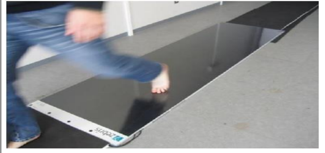
Görsel 2.3. Zebris medikal platform tabanlı ayak basınç sensörü
