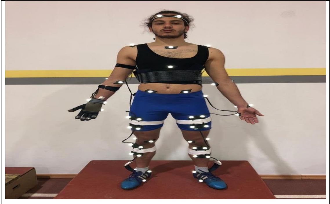
Görsel 3.10. Yansıtıcı işaretlerin yerleştirilmesi
