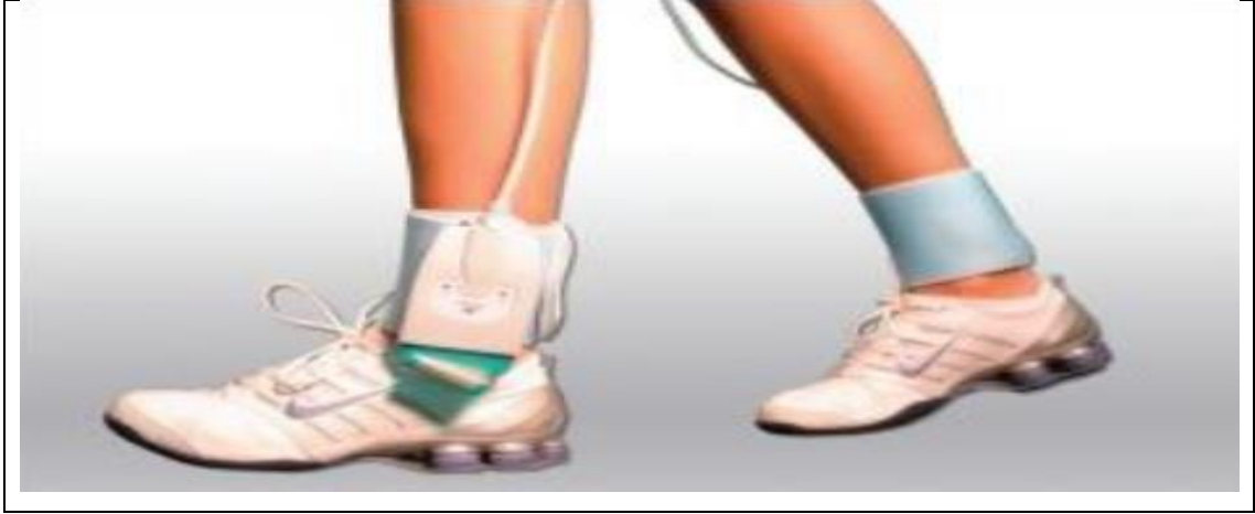
Görsel 2.4. Tekscan F-Scan ayakkabı içi plantar basınç sensörü (Razak vd., 2012)
