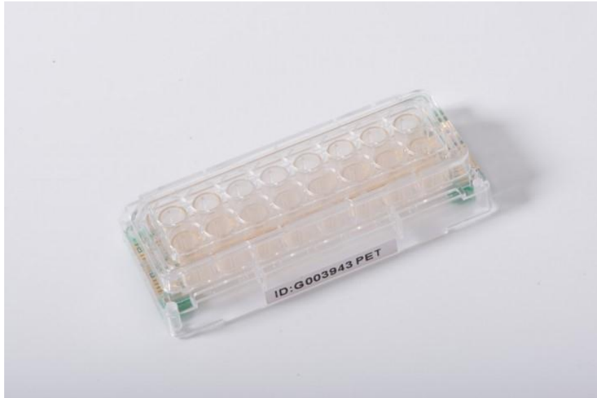
Şekil 3.2. xCELLigence RTCA-DP sisteminde kullanılan 16 kuyucukulu E-plaka
