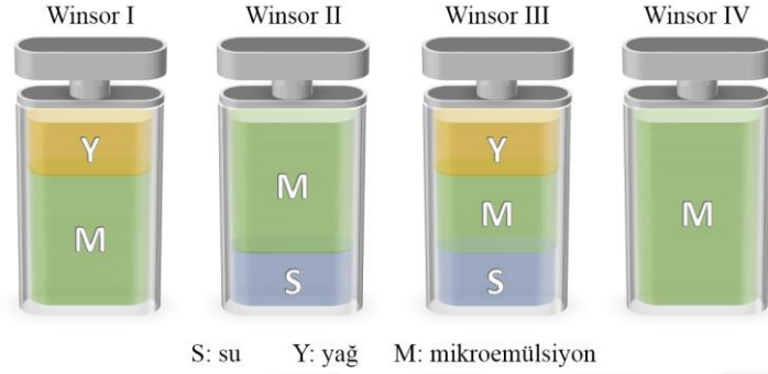
Şekil 2.3. Winsor'un denge durumlarına dayalı mikroemülsiyon sınıflandırması (Peng vd., 2011)
