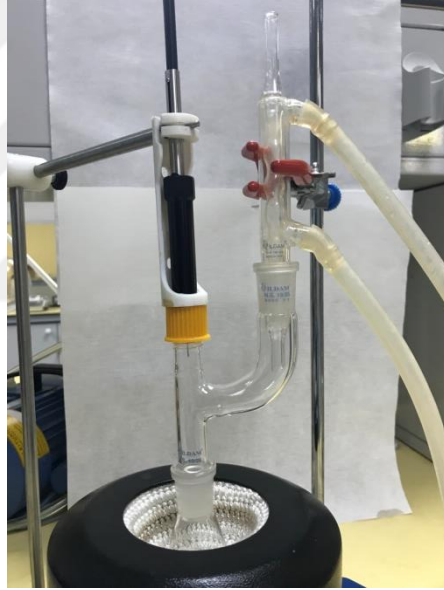
Şekil 3.4. Ekstraksiyon için kullanılan MSD-SPME düzeneği
