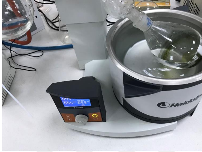
Şekil 3.3. Çözücülerin düşük basınç altında rotavaporda uzaklaştırılması
