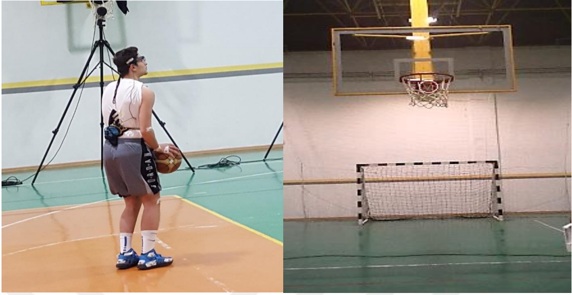
Görsel 3. 12. Tobii Pro Glasses2 göz takip sistemi ile qualisys hareket analiz sistemlerinin serbest atış aşamasında eş zamanlı kullanımı
