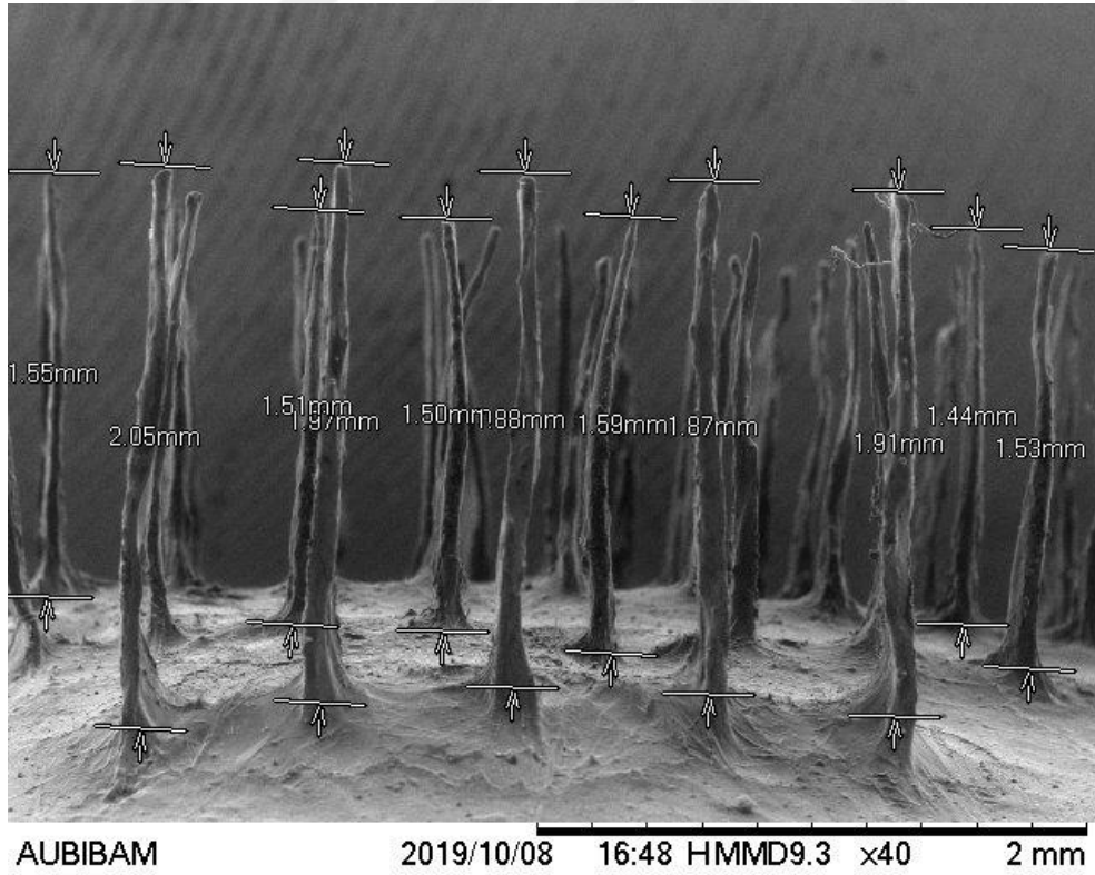
Şekil 5.32. CMC-F3 mikroigne formülasyonlarına ait SEM görüntüleri
