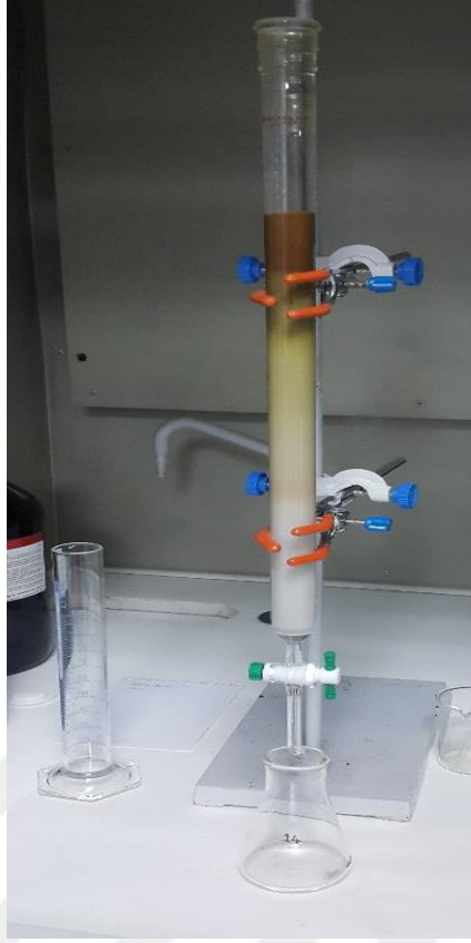
Görsel 4.5. Etil asetat ekstresinin kolon kromatografisi ile fraksiyonlanması
