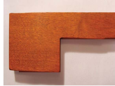
Resim.3 Pernambuco ağacının teğet kesiti
