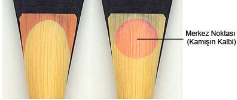
Şekil 34 - Uç Makinesinin Kazıma Bölgeleri ve Kamışın Merkez (Kalp) Noktası
