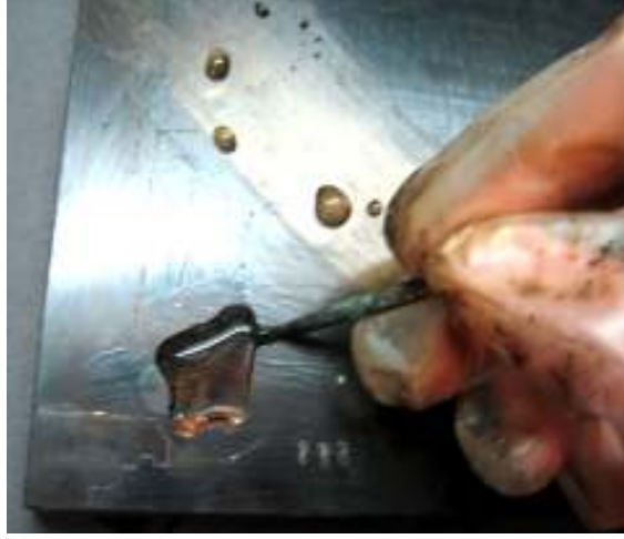
Resim 9: Asfalt Kaplı Kalıba Fırçayla Asit Uygulama
