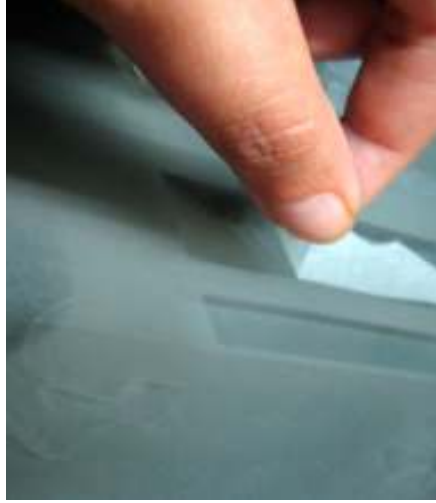
Resim 16: Kumlama Folyosu İle Kaplanıp Kumlanmış Kalıp
