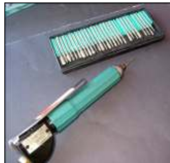
Resim 20: Güçle Çalışan Esnek Saplı Gereç Ve Elmas Uç Seti
