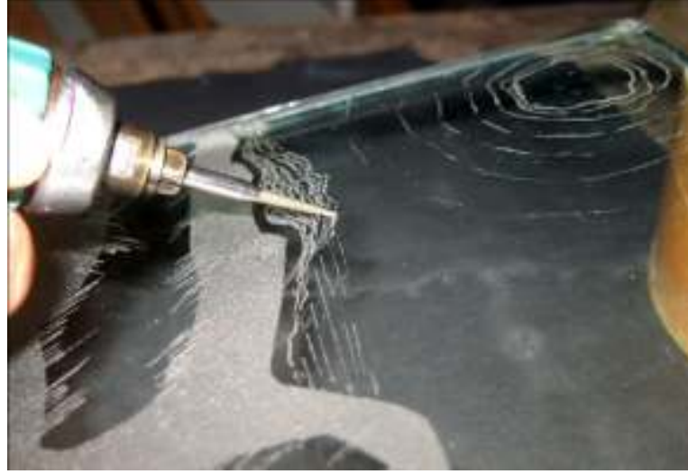
Resim 21: Güçle Çalışan Esnek Saplı Gereç ile Kalıbın Çizilmesi
