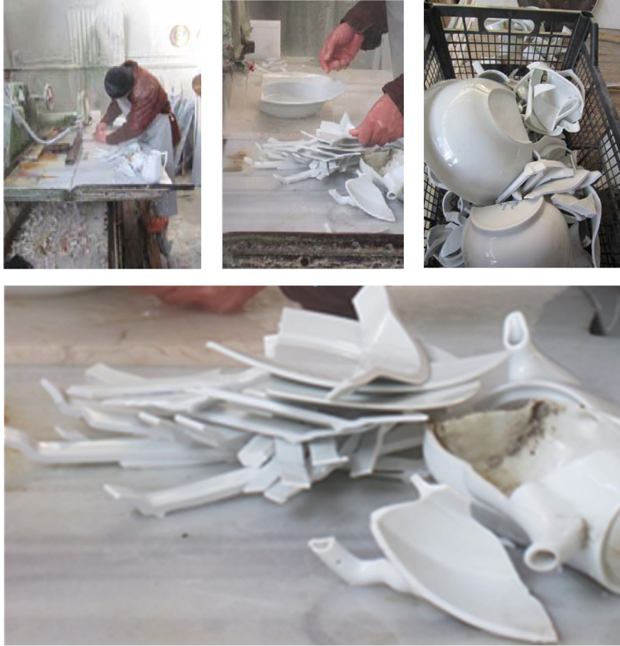
Görsel 349. Görsel 350. Görsel 351. Görsel 352. Atık porselen parçalarının Afyon Mermer Atölyesi'nde gerçekleşen kesim işi
