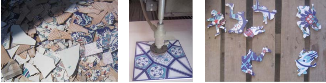
Görsel 415. Güven Çini'nin atık sahası Görsel 416. Ankara İvoksan'da bulunan Metranom Water Jet CNC Kesim, uygulaması Görsel 417. Kesimi tamamlanan atık çiniler Fotoğraf: Elif Ağatekin
