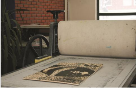
Resim 30, Ađaç kalıbın paspartuya yerleřtirilmesi
