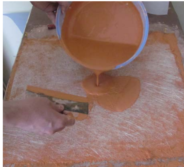
Resim 123. Cam Elyaf Parçanın Diğer Yüzeyine Çamur Dökülmesi (Fotoğraf: Orçun Aksakal)
