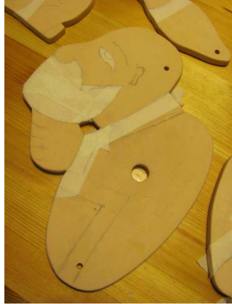
Resim 131. Sırlanmak üzere şablonları hazırlanmış bisküvi parçalar (Hacivat-Karagöz) (Fotoğraf: Orçun Aksakal)
