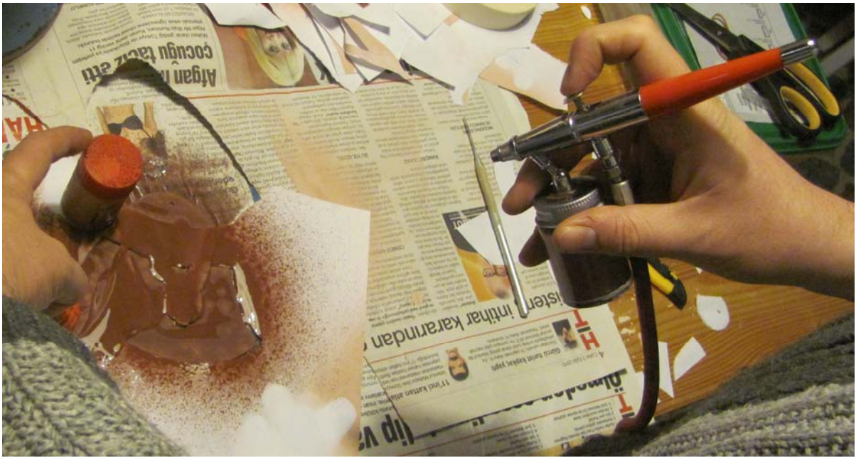
Resim 134. Şablonları hazırlanan Keraflex parçanın air-brush ile boyanması (Fotoğraf: Ufuk Gülaçtı)
