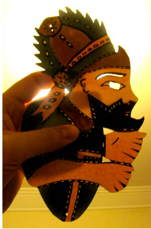
Resim 150. Keraflex'in ışık geçirgenliğe örnek (Fotoğraf: Orçun Aksakal)
