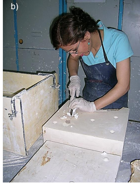
Görsel 69. a) Strafordan Yapılmış Modelin Alçı Kalıbının Hazırlanması b) Alçı Kalıptan Straforun Çıkartılması.
