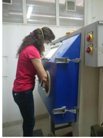
Görsel 21. Kumlama Makinesi İle Kumlama İşlemi
