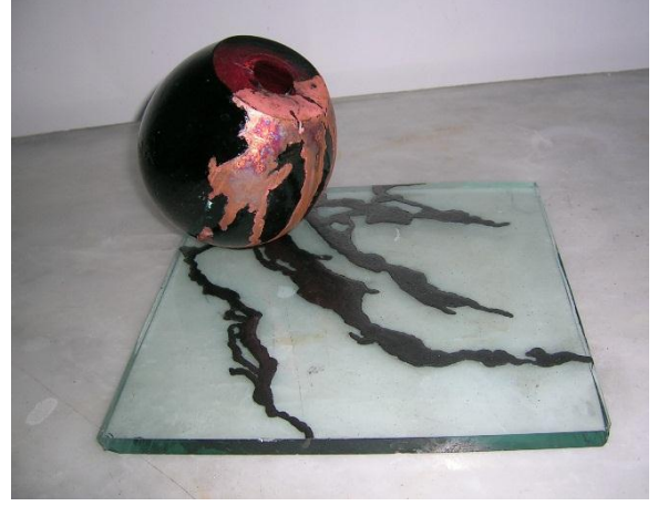
Görsel 65. Yüzeyde Oluşan İnce ve Renkli Bakır Tabakası. Elektrokaplama İşleminin Tamamlanmamış Hali
