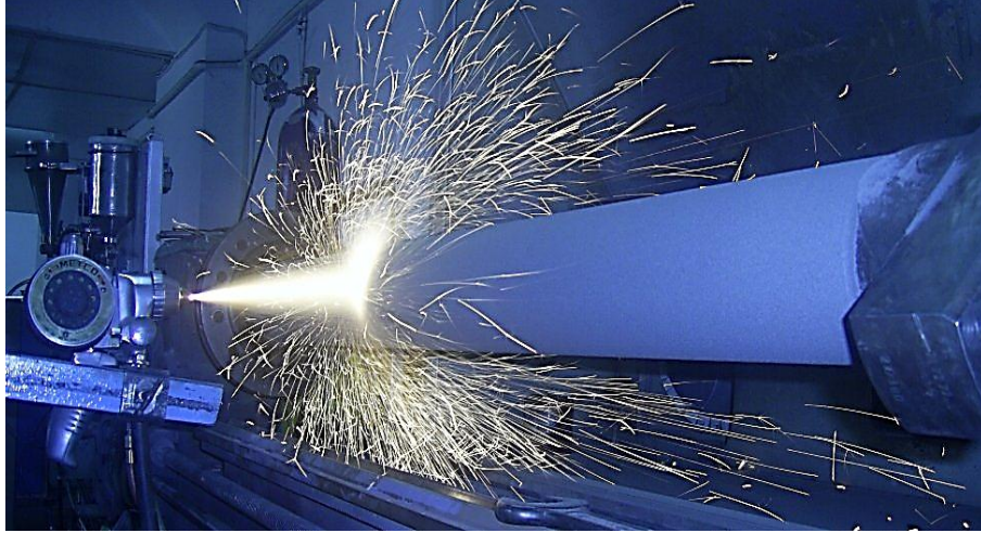
Görsel 12. Sıcak Tel Püskürtme Uygulaması
