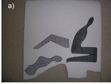
Görsel 68. a) Üç Boyutlu Programda Çizilmiş Olan Modelin Strafor Model Malzemesi Üzerine Yapıştırılması b) Strafor Modelin Kesilmesi İşlemi.
