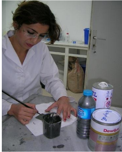
Görsel 44. Sistemik Çalışmalar İçin Toz Grafiti ve Vernik Karışımı ile Cam Yüzeyinin Metalizasyonu.
