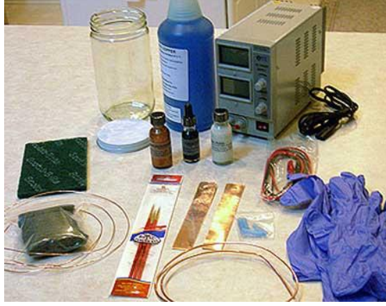
Görsel 16. Kaplama Kiti ve Prosede Kullanılan Malzemeler
