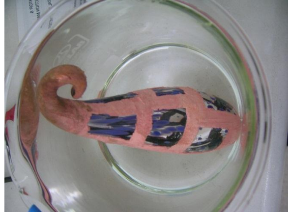
Görsel 55. Elektrokaplama İşlemi Bitmiş Olan Mat Yüzey.
