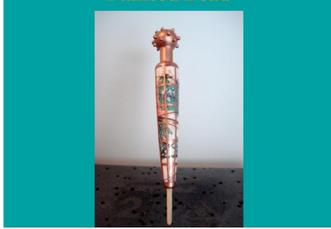
Görsel 25. Bakır Pasta İle Boyanıp İletken Hale Getirilmiş Cam Yüzeyi
