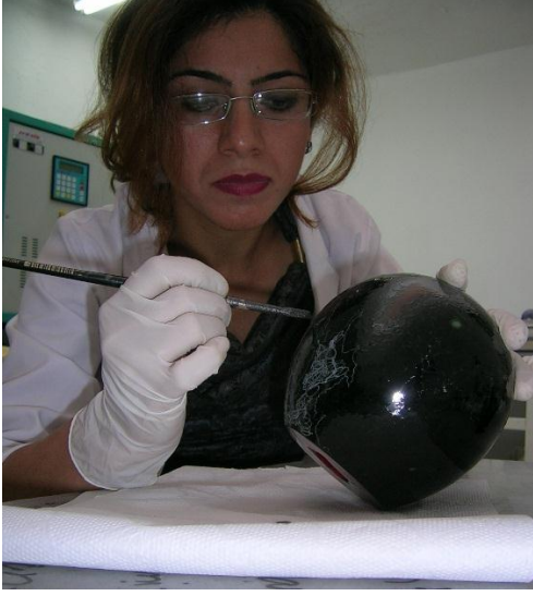
Görsel 64. Cam Yüzeyine Fırça ile Grafit Uygulaması
