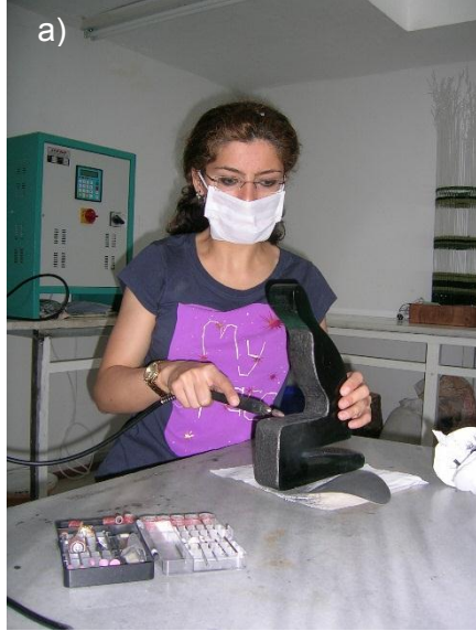
Görsel 74. a) Grafit Kuruyunca El Matkabı İle Yüzeyin Düzleştirilmesi b) Kaplama İçin Fazla Grafitleri Temizlenmesi.
