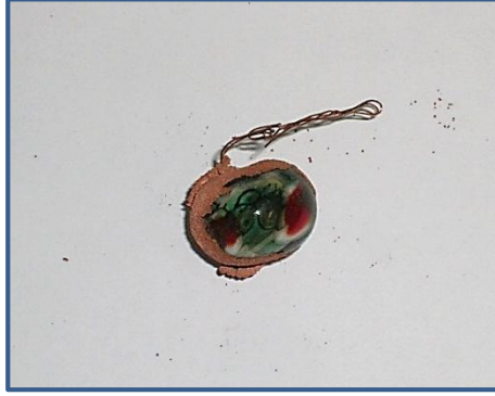
Görsel 43. Ticari ve Toz Grafitle Boyanmış, 0,3 V Uygulanarak Kaplanmıştır.
