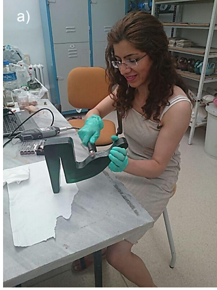
Görsel 73. a) Soğuk İşlemden Sonra Yüzeyin Pürüzlendirilmesi b) Pürüzlendirme İşleminin Ardından Grafit Sürülmesi.
