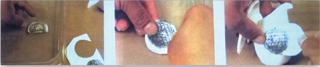
Görsel 84: Dekalin seramik yüzey üzerine uygulanması
