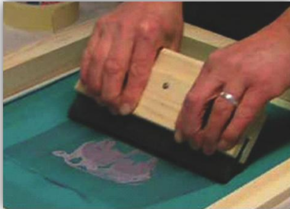
Görsel 76: Ragle ile boyanın çekilmesi
