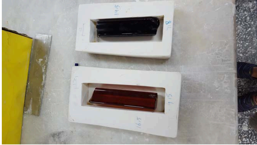
Görsel 3.14. Kalıplar içerisine yerleştirilen kütle camlar
