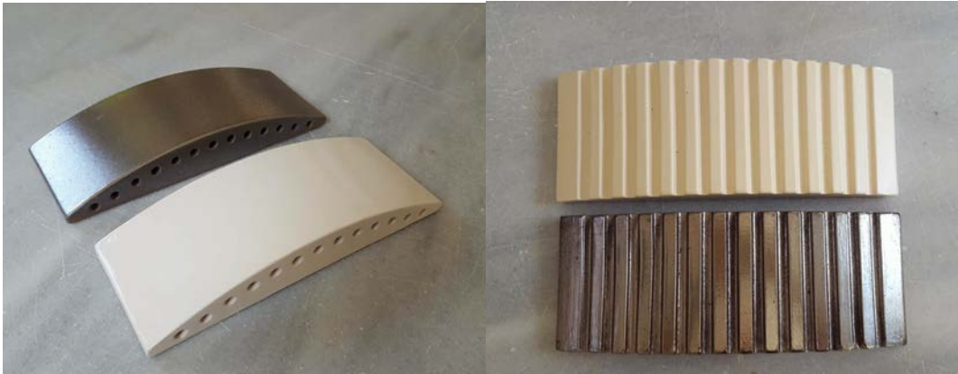
Görsel 3.9. Bisküvi pişirimi yapılmış olan seramik yüzeylerde farklı sırlar denenmiştir.
