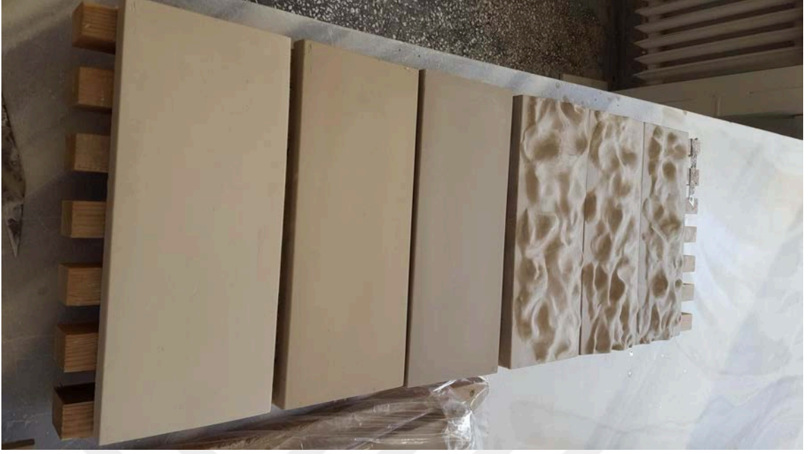
Görsel 3.6. 1060 °C'de fırınlanmış seramik birimler
