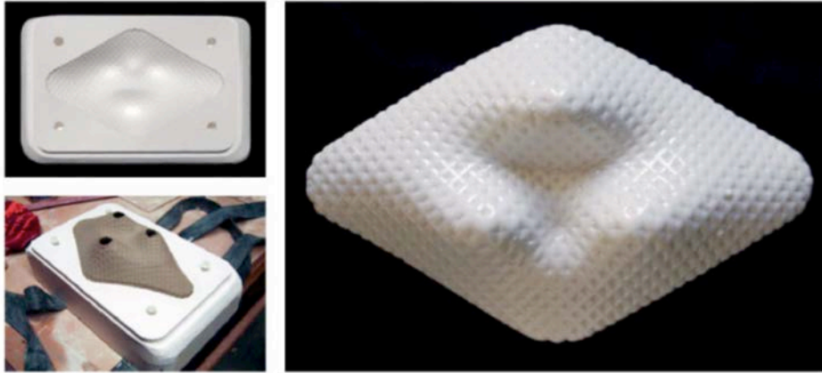
Görsel 2.37. Jonathan Grinham tarafından döküm yöntemiyle üretilmiş seramik modül
