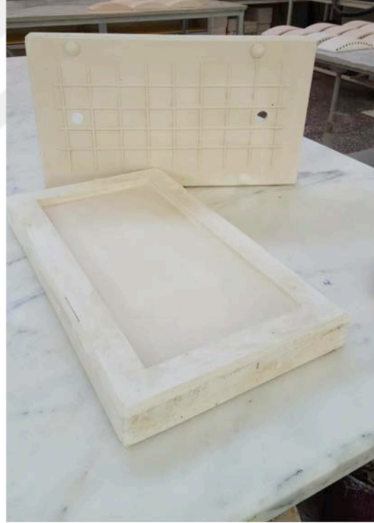
Görsel 3.11. 30 x 40 ebatlarında alçı üretim kalıbı
