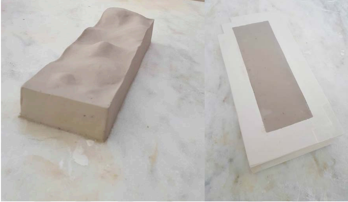
Görsel 3.2. Solda 11x30 ebatlarında çamur model, sağda model üzerinden alınan alçı kalıp
