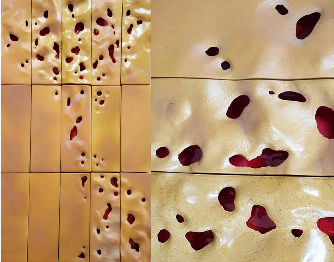
Görsel 3.5. 1060 °C'de fırınlanmış seramik birimler
