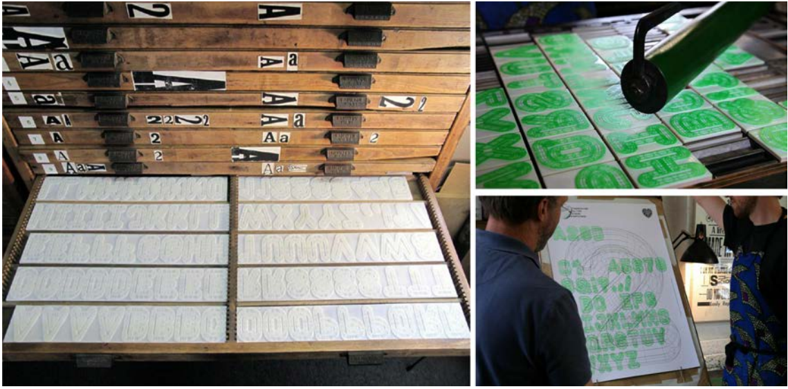
Görsel 81. 3D yazıcı ile üretilmiş tipo baskı fontu 'A23D'.
