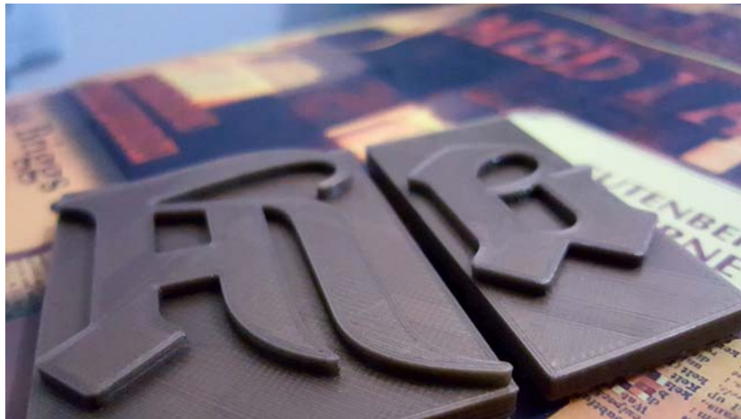
Görsel 84. Bu araştırma için sayısal olarak hazırlandıktan sonra, 3D yazıcı ile üretilen Gutenberg'in Textura yazı karakterinin majiskül ve miniskül 'A' harfleri..
