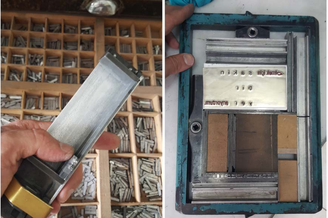
Görsel 94. Çembere bağlanmış ve baskıya hazır halde magnezyum klişe ve el dizgisi metal hurufat. Kaynak: Konur Koldaş görsel arşivi, 2016.
