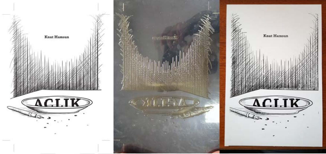
Görsel 80. Sayısal tasarım, fotopolimer kalıp ve baskı sonucu.
