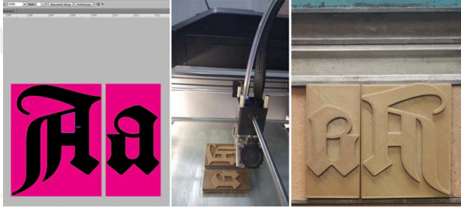
Görsel 88. Vektörel olarak oluşturulan Gutenberg İncili'nin yazı karakteri Textura'nın majiskül ve miniskül 'A' harfleri, 3D yazıcıda yapım aşaması ve bitmiş harflerin çemberde baskıya hazır halleri.
