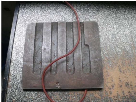
Görsel 27. Rezistanslı sıcak yıldız baskı altlığı Kaynak: M.E.B. 2008: 7.
