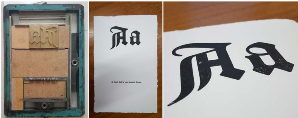
Görsel 89. 3D yazıcı ile hazırlanan Gutenberg İncili'nin yazı karakteri Textura'nın majiskül ve miniskül 'A' harfleri ve tipo baskı sonuçları.
