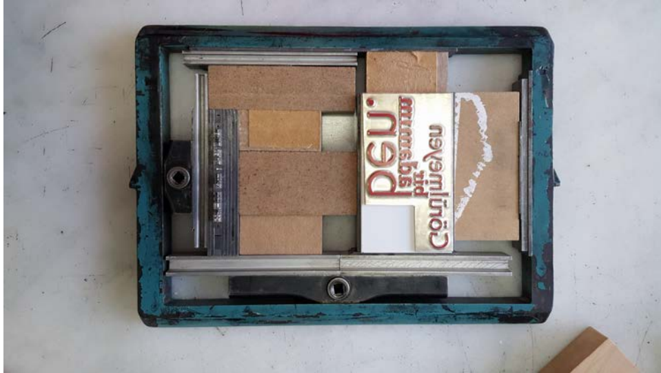
Görsel 79. El pedalı çemberine bağlanmış metal (magnezyum) klişe.
