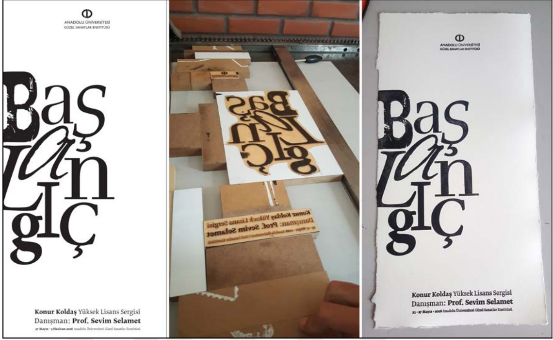
Görsel 92. 1.7 mm derinlikte fotopolimer kalıplarla basılan uygulama projesi sergi afişi (Sayısal tasarım, baskı yatağına bağlanmış fotopolimer kalıplar ve baskı sonucu).
