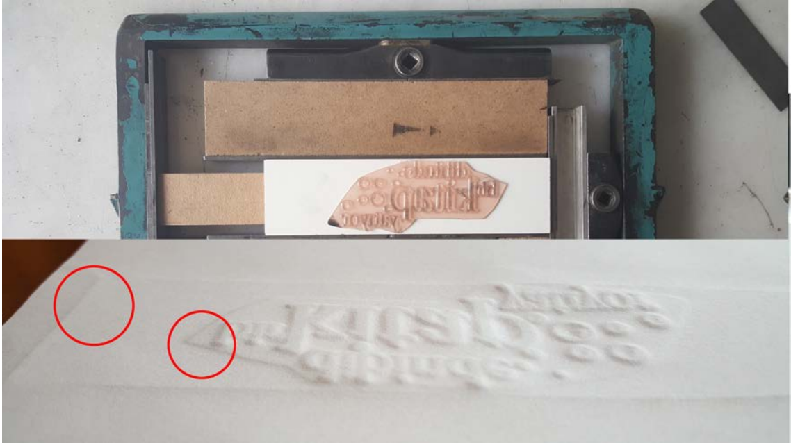
Görsel 91. 1.7 mm derinlikte fotopolimer kalıplarla nemli kağıt kullanımında yaşanan fazla baskı sorununa örnek görsel.
