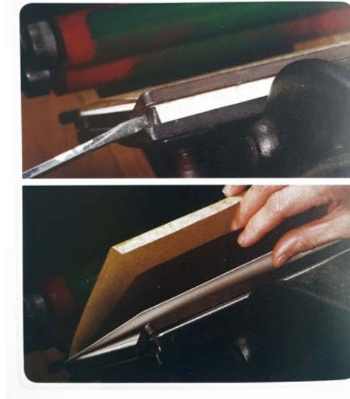
Görsel 77. Kazan mizantreni ayarı için kazan kağıdına ekleme yapma işlemi.
