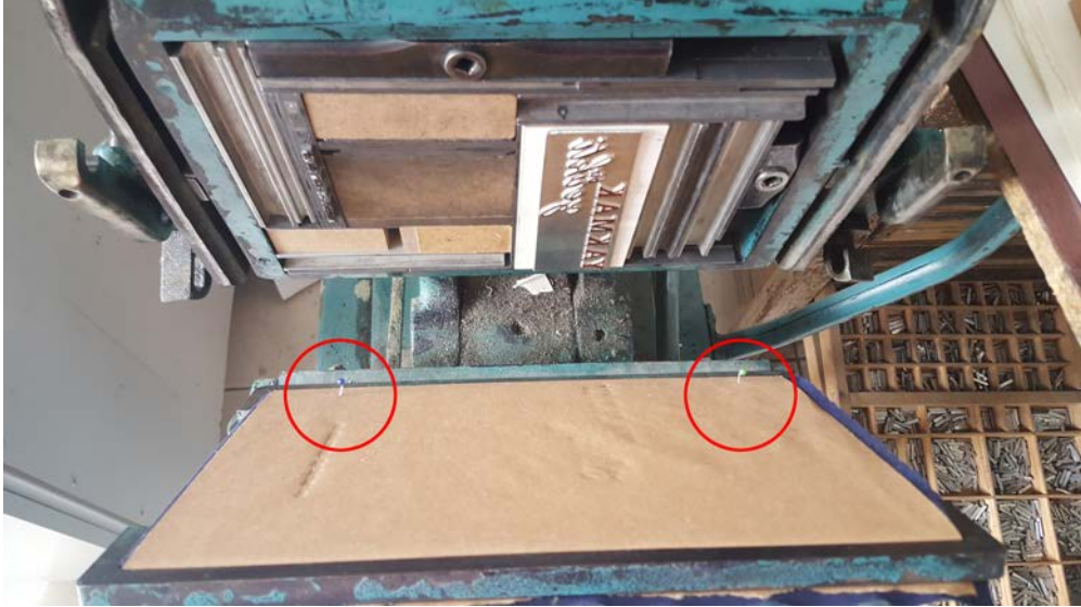
Görsel 96. Kazan kağıdı üzerine yerleştirilen, basılacak kağıtların konumunu belirleyen ve kağıtların sabit kalmalarını sağlayan poza iğneleri.
