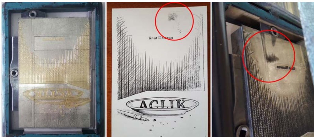
Görsel 90. 0.95 mm derinlikteki fotopolimer kalıplarda yaşanan merdanelerin zemin boyama sorununa örnek bir görsel.
