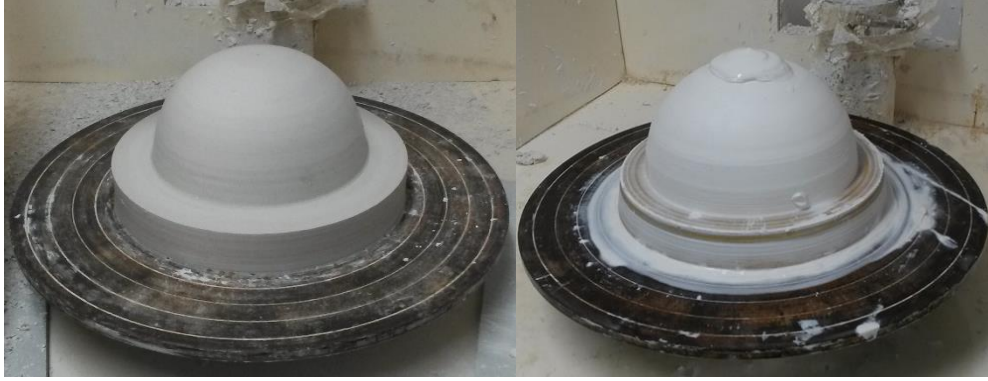
Görsel 4.1. Alçı Torna Kullanılarak Model Yapım Aşaması
