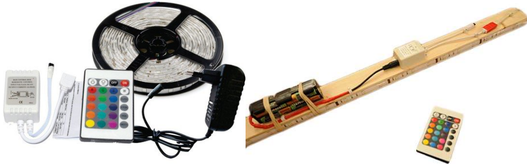
Görsel 2.12. Herhangi bir düzeneğe sabitlenmemiş LED şerit, renk kumandası, şehir elektriğine bağlayabilmek için adaptör ve böyle bir düzeneğin 1.5 voltluk pillerle kullanılmak üzere çıtaya monte edilmiş hali
