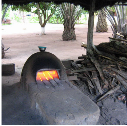
Görsel 2.3. Balçık Haline Getirilmiş Topraktan Yapılmış Fırın (2) Kaynak: http://sankofa.com.au/images/Beads4-lg.jpg (23.04.2016)
