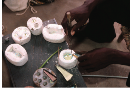
Görsel 3.1. Toz Cam Tekniğiyle Bir Boncuk Üretmek İçin Hazırlanmış Dikey Kalıp Kaynak: http://www.mitpressjournals.org/doi/pdf/10.1162/AFAR_a_00119 (13.10.2015)
