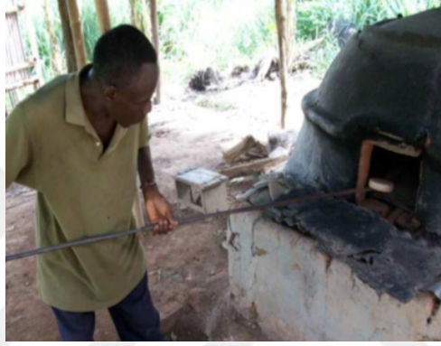
Görsel 3.7. Fırın İçine Kalıpların Yerleştirilmesi
