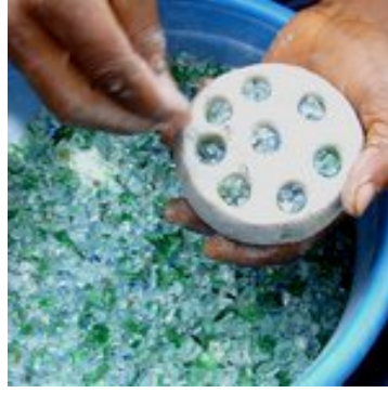
Görsel 3.5. Cam Kırıklarıyla Doldurulan Kalıp Kaynak: http://www.ghanacraft.com/bead-making.htm (13.10.2015)
