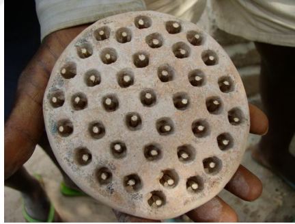
Görsel 3.4. Manyok Yaprakının Saplarının Yerleştirildiği Kalıp Kaynak: http://blog.happymangobeads.com/tag/sandcast-beads/ (23.04.2016)
