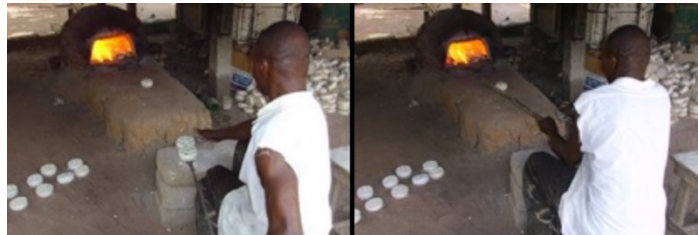
Görsel 3.6. Boncukların Fırınlanması Kaynak: http://www.ghanacraft.com/bead-making.htm (13.10.2015)
