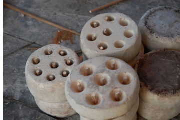
Görsel 1.11. Manyok Saplarının Yerleştirildiđi Boncuk Kalıpları
