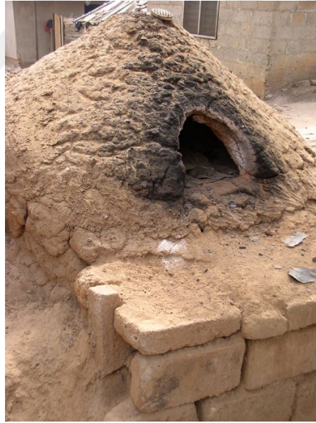
Görsel 2.4. Cam Boncukları Pişirmek İçin Açık Toprak Fırın Kaynak: http://blog.happymangobeads.com/2013/01/making-sandcast-glass-beads-ghana-africa/if-196/ (23.04.2016)
