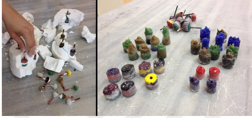
Görsel 4.9. Pişirimi Tamamlanan Boncukların Kalıptan Çıkarılması Kaynak: Serap Bedel Özek (13.07.2016)
