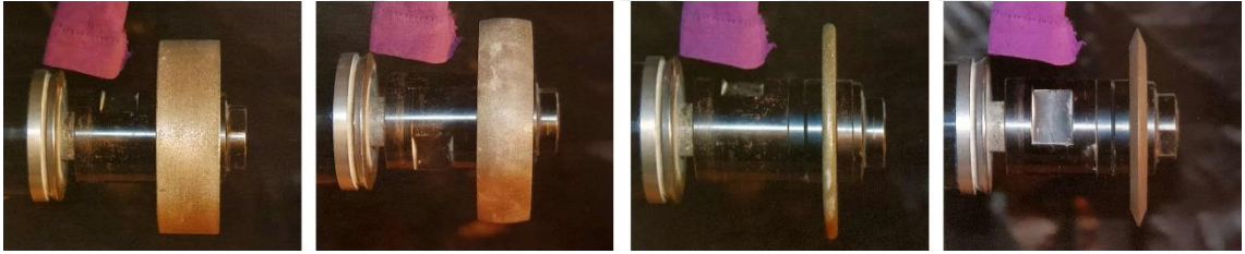
Görsel 2.41. Farklı şekil ve boyutlarda, farklı kesim, kazıma ve doku sağlayabilen elmas diskler (Schmuck, 2009, s. 100)
