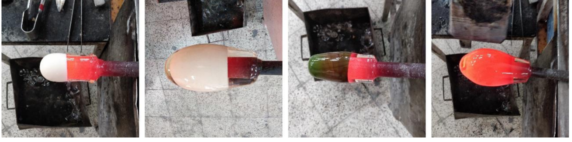
Görsel 3.4. Fon rengi olacak beyaz cam bar çubuk ilk pipo ucuna alınıp eritilir ve üzerine tekrar cam sarılarak bir miktar üflenir. Aynı işlem ikinci katmanı oluşturacak olan zıt renkli cam bar çubuk için de uygulanır
