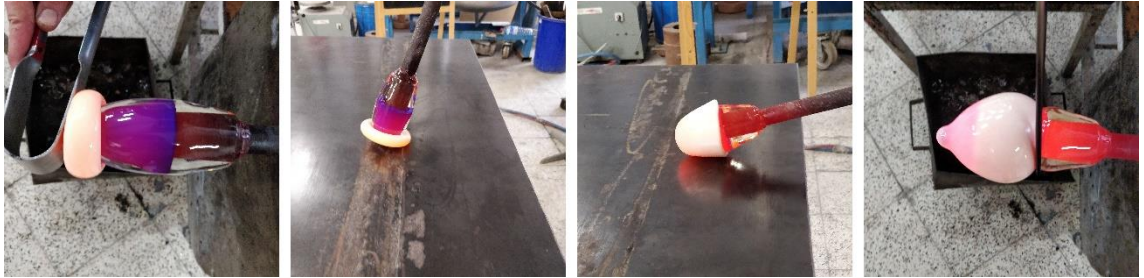
Görsel 3.7. Fıska ucuna alınmış fon olacak mavi cam bar çubuk üzerine beyaz cam bar çubuk eritilerek yapıştırılır. Sonra, çelik masa kullanılarak yuvarlama işlemiyle giydirilir ve ön şekillendirme yapılır (Serkan Özer fotoğraf arşivi)
