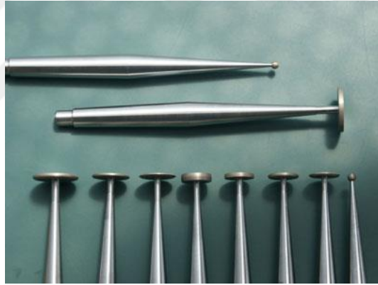
Görsel 2.43. Torna tezgâhında kullanılan çeşitli boy ve şekillerde sinterlenmiş elmas uçlar/diskler ( http://www.merker-kmk.com/indexe06.html , Erişim Tarihi: 15.03.2019)
