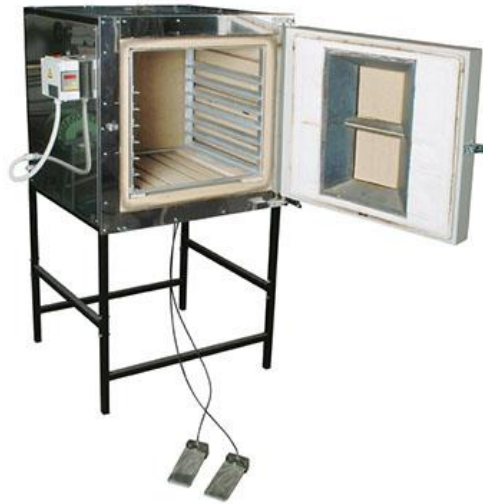
Görsel 2.26. Elektrikle çalışan tavlama fırını
