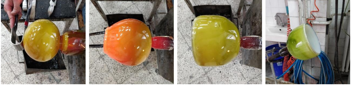
Görsel 3.6. İşlenmemiş objenin ön şekillendirmesi yapıldıktan sonra noble ucuna alınarak hem ağız kısmı düzeltilir hem de istenilen formun son hali verilir ve ardından tavlama fırınına yerleştirilir (Serkan Özer fotoğraf arşivi)
