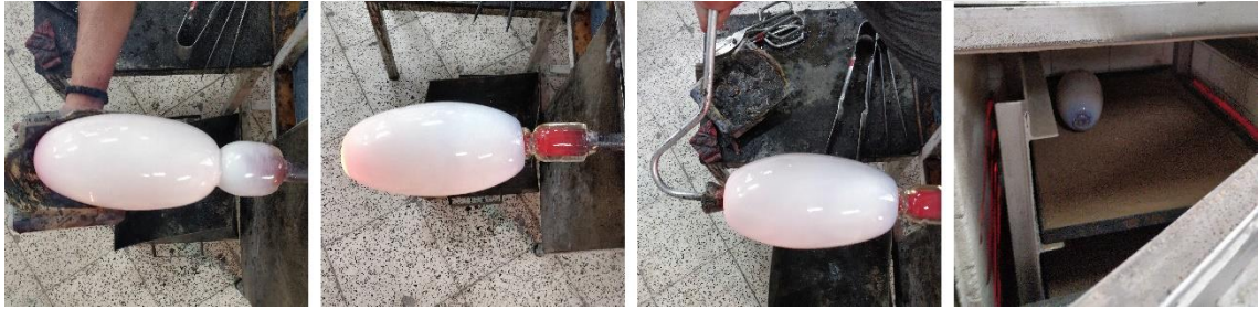
Görsel 3.3. Son katmanı da renklendirilen cam, üflenerek ve şekillendirileler formu verilir ve sonra noble ucuna alınarak ağız kısmı düzeltilerek, soğuması için tavlama fırınına yerleştirilir
