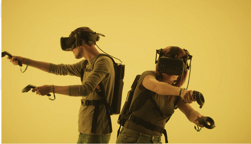
Görsel 3.21. VR teknolojisinde kullanılan gözlük, backpack ve konsol örneği. ( https://illucity.fr/en/standard/illucity-immersive-experience/ Erişim Tarihi: 15.04.2019)
