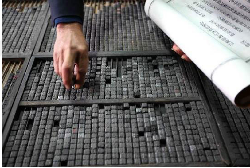
Görsel 2.7. Bi Sheng'in icat ettiği hareketli tip baskı kalıpları. http://www.historygraphicdesign.com/images/19/W6.jpg Erişim Tarihi: 15.03.2019
