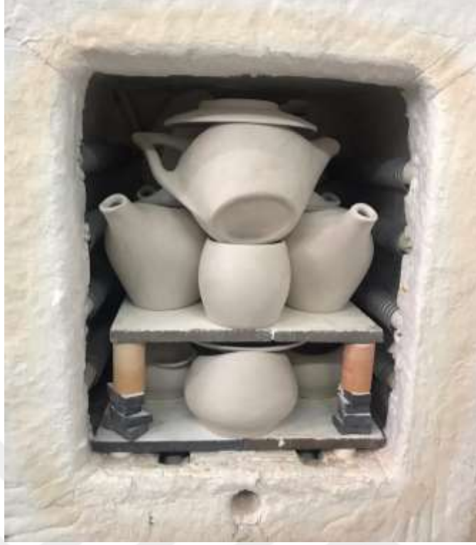
Görsel 4.14. Ürünlerin bisküvi pişirimi için fırına yerleştirilmesi
