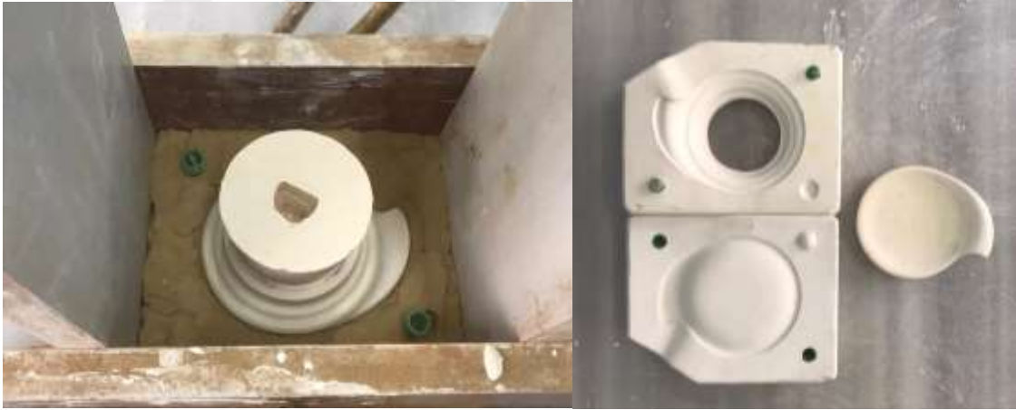
Görsel 4.6. Şekerlik kapağı kalıp aşaması ve kalıbı
