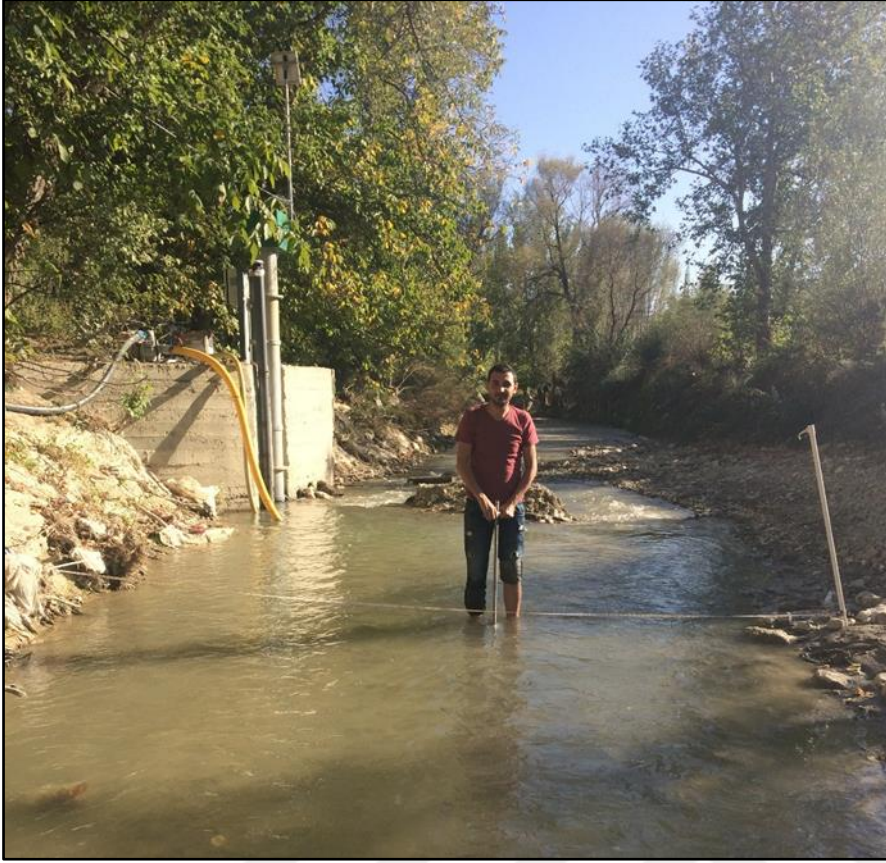
Fotoğraf 3.9 Akım ve Sediman Ölçümünde Akarsu En Kesit Genişliğinin Şerit metre Yardımıyla Belirlenmesi
