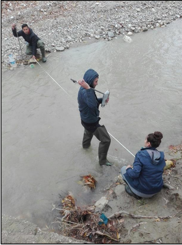
Fotoğraf 3.14 DH-48 kodlu Sediman Numune Alıcısıyla Akarsuyun Enine Kesitinden Askıda Sediman Örnek Alma Aşamasından Bir Görünüm
