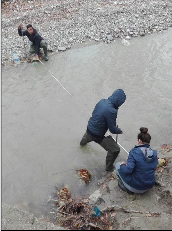
Fotoğraf 3.15 Korkuteli Havzasında Belirlenen Kontrol Kesitte Geniş Kesiti Temsil Eden Ara Kesitlerin İşaretlendiği Dikeylerde Sediman Numune Alma İşlemi
