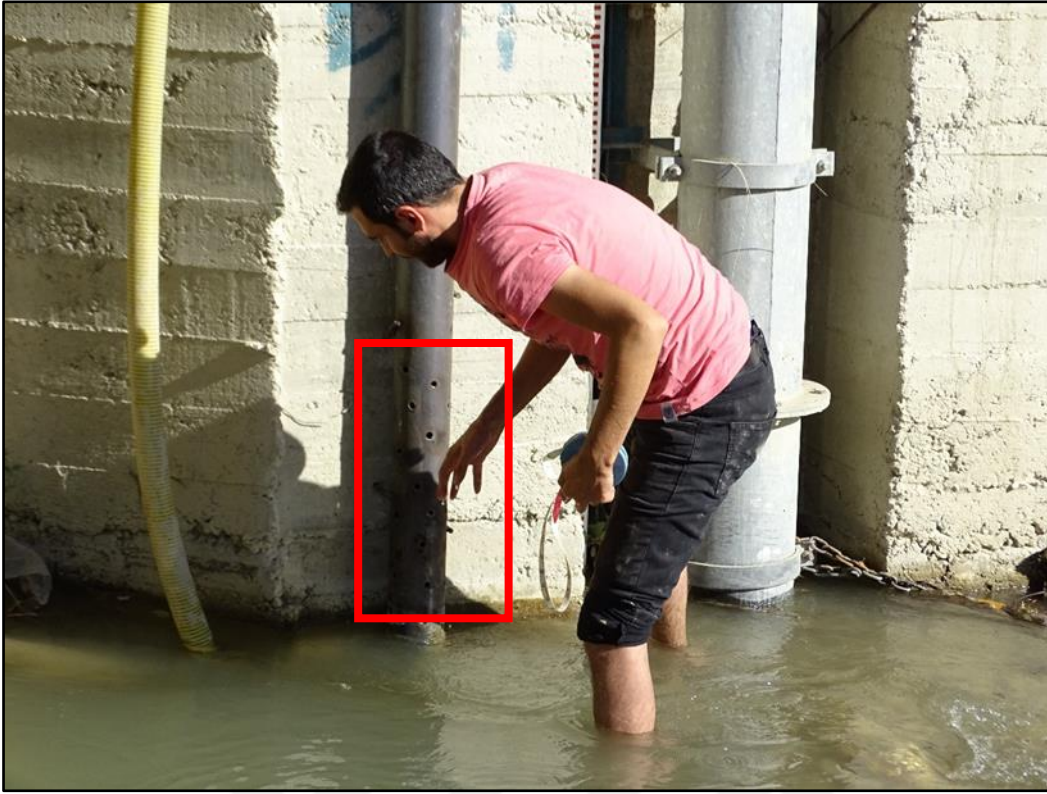
Fotoğraf 3.3 Daldırma Tip Seviye Sensörünün Demir Borunun İçine Sabitlendiği Düzenekten Bir Görünüm
