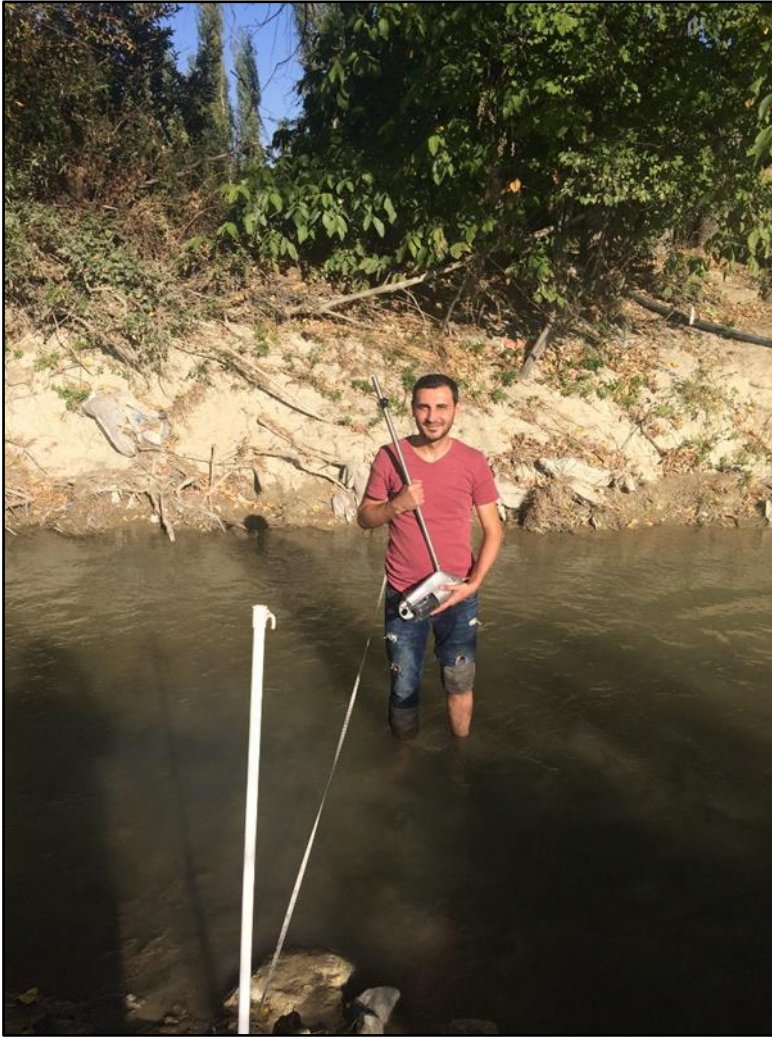
Fotoğraf 3.10 DH-48 Kodlu Elden Sediman Numune Alma Cihazı ile Örnek Alma Aşaması
