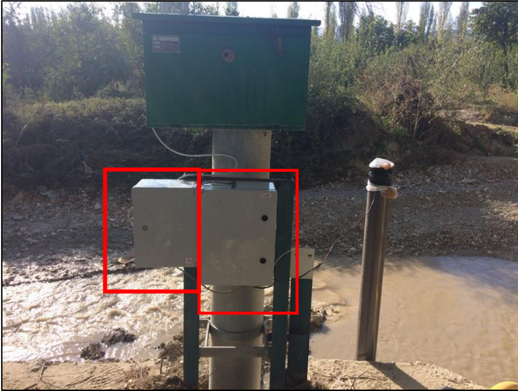
Fotoğraf 3.4 Enerji Panosu ve Seviye Sensörü Ölçümlerinin Kaydedildiği Cihazdan Bir Görünüm
