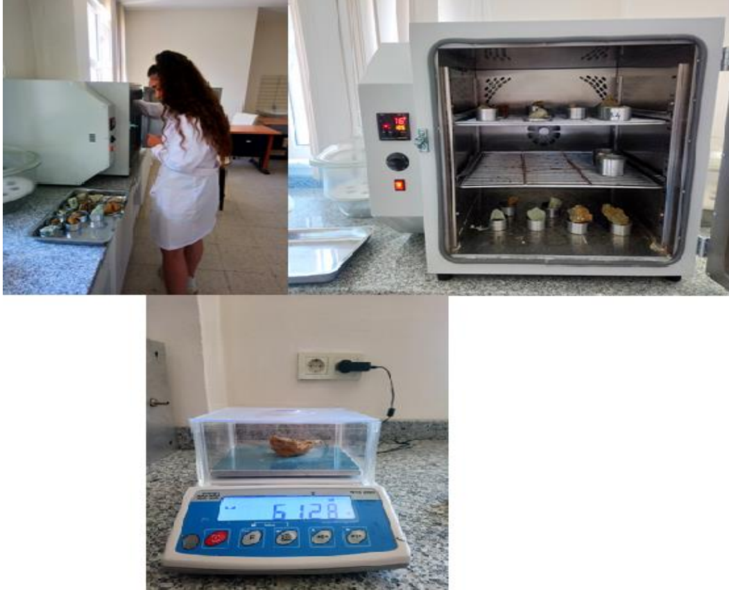
Fotoğraf 1.4. Gözeneklilik Tayininde Kullanılan Etüv ve Hassas Terazi
