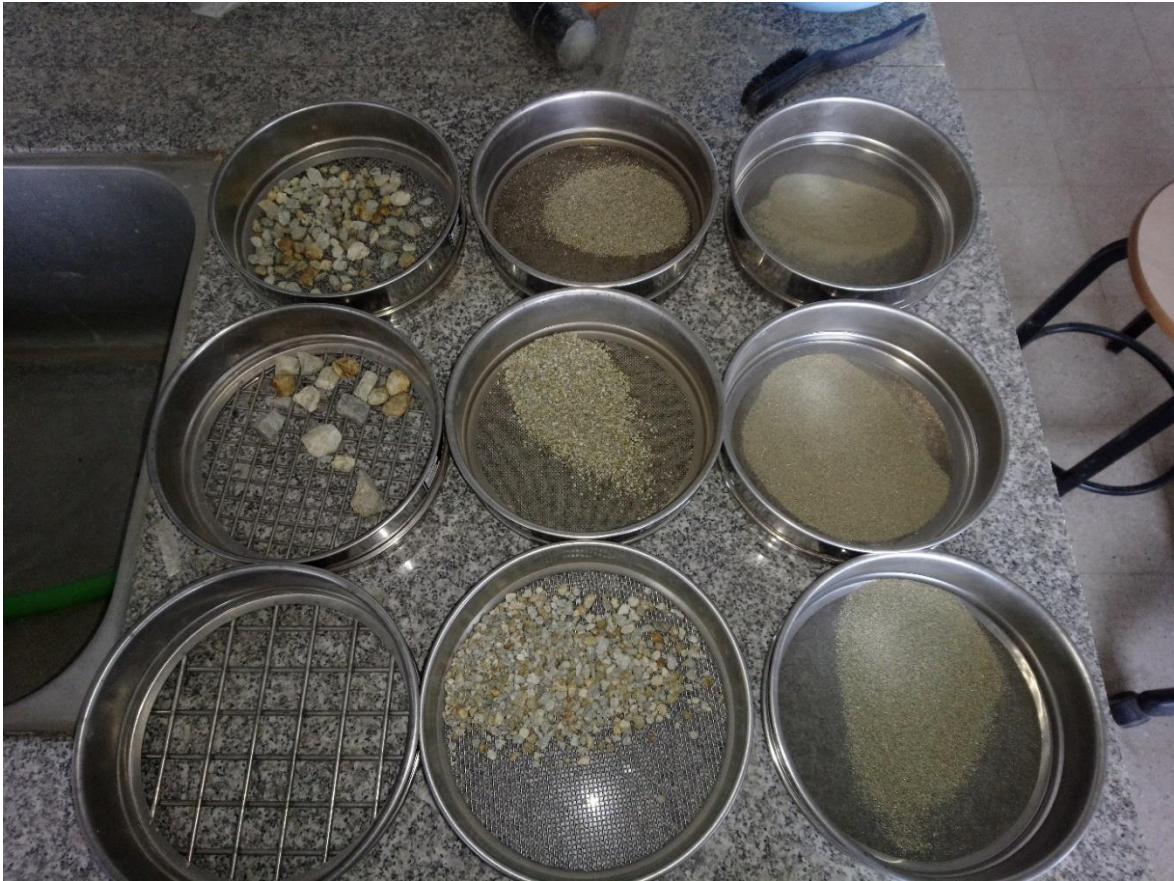
Fotoğraf 1.2. Tane Boyu Dağılımı Analizinde Kullanılan Çeşitli Açıklığa Sahip Eleklerden Bir Görünüm
