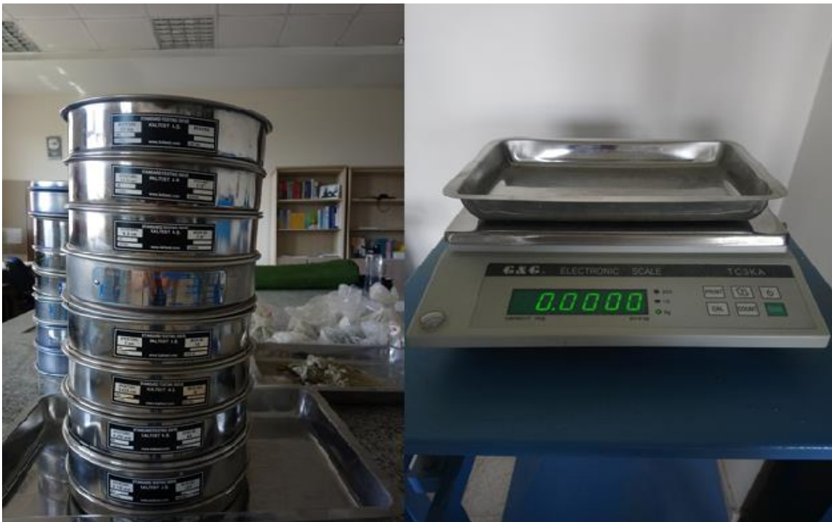
Fotoğraf 1.1. Tane Boyu Analizinde Kullanılan Çeşitli Boyda Elekler ve Hassas Terazi
