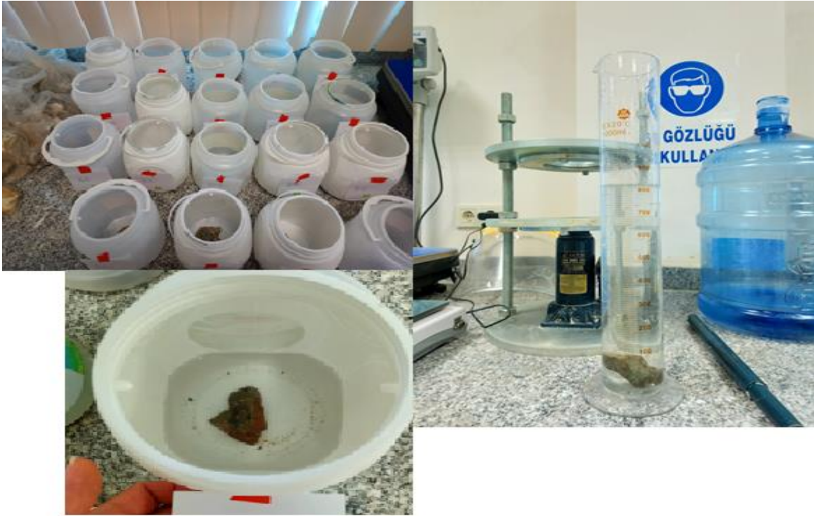
Fotoğraf 1.5. Gözeneklilik Tayininde Kayaç Numunelerinin Suya Doyurma Aşaması ve Numunelerin Hacim Oranlarının Ölçülmesi
