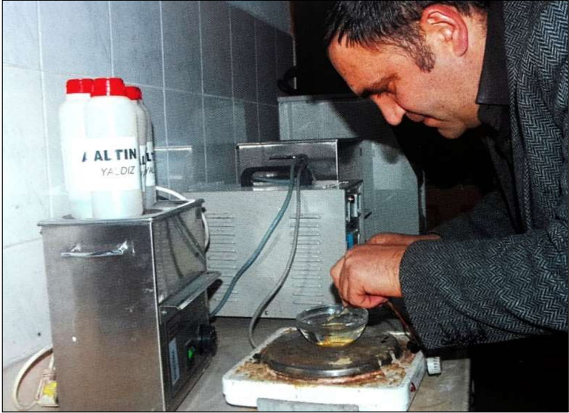
Şekil 118: Elektroliz Yöntemi İle Gümüşe Altın Yıldız Kaplayan Usta
