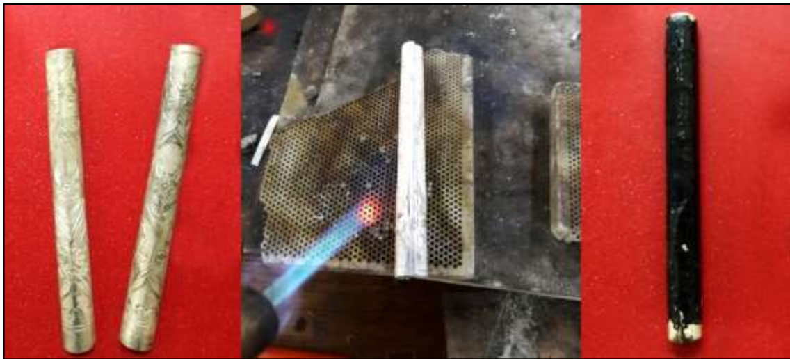
Şekil 292: Heştekte Zımbalarla Yuvarlatılmış Levhalar, Birleştirme İşlemi ve Savat Mahlûlünün Sıvama Sonrası Görünüşü
