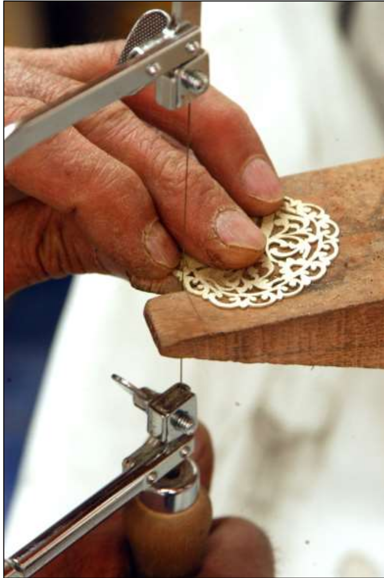
Şekil 111: Kıl Testereyle Delik İş (Ajur) Yapan Erzurumlu Bir Usta
