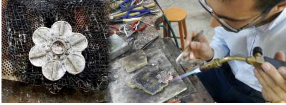
Şekil 306: Tellerin Astar Üzerine Kaynatılması
