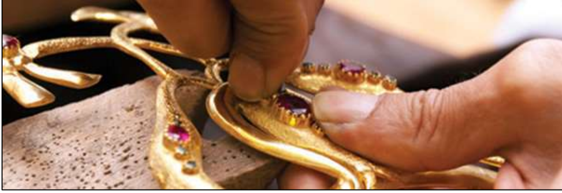
Şekil 106: Altın Broş Üzerine Mıhlama Tekniği Uygulaması (www.ismek.ibb.gov.tr, 15 Mayıs 2015)
