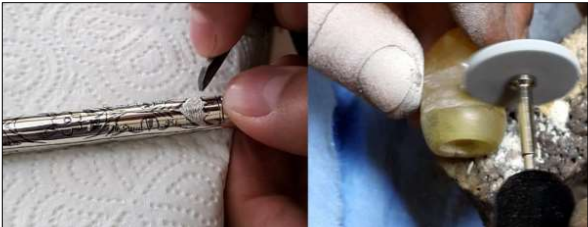
Şekil 294: Ağızlığa Kalem Atma İşlemi ve Kehribarın Şekillendirilmesi
