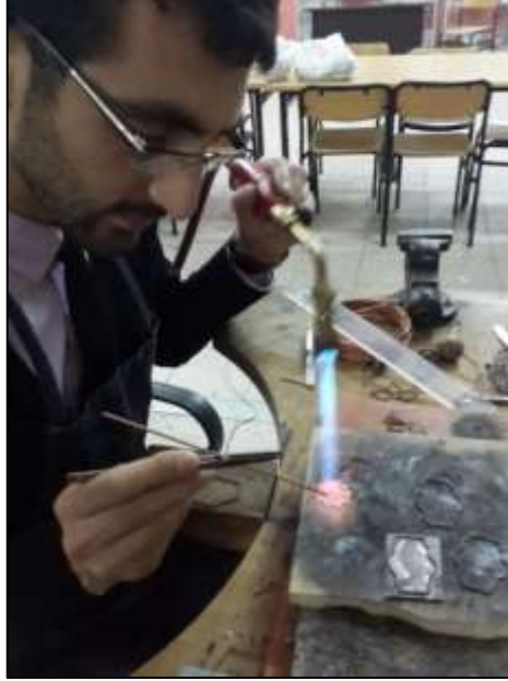
Şekil 300: Telkâri Tekniğiyle Hazırlanmış Gül Motifinin Kaynatılması
