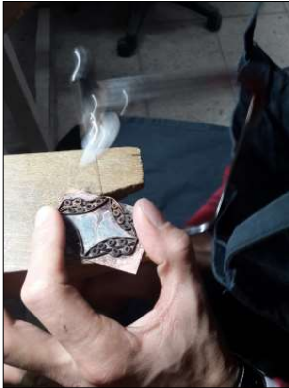
Şekil 299: Astar Fazlalıklarının Kıl Testereyle Kesme İşlemi
