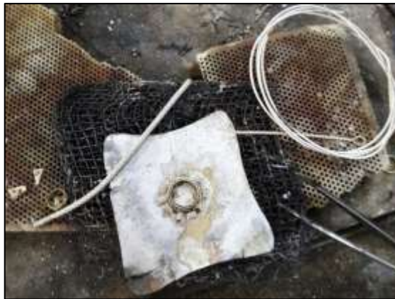
Şekil 305: Broşun Yapımı İçin Hazırlanan Astar ve Teller
