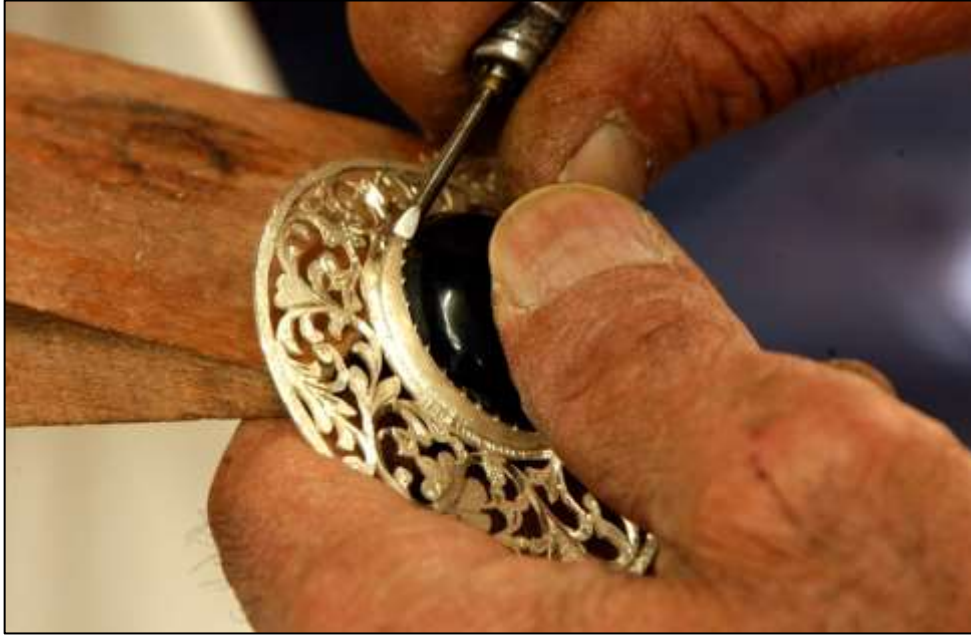
Şekil 107: Ajur ve Kalem İşi İle Süslenmiş Takıya Mıhlama Yapılırken
