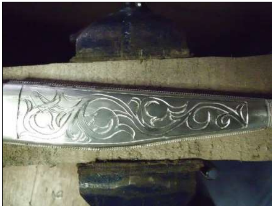
Şekil 98: Savat Ustası İbrahim Sami ÖZEN Tarafından Kalem Atılarak Savatlamaya Hazır Gümüş Bıçak Kını
