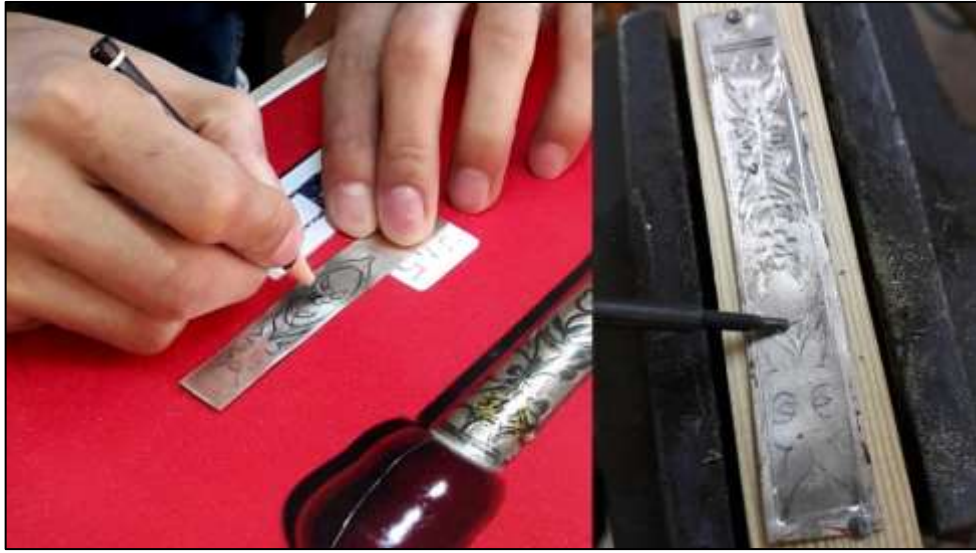
Şekil 291: Levha Üzerine Desen Çizimi ve Desenleri Metal Üzerinden Boşaltma İşlemi
