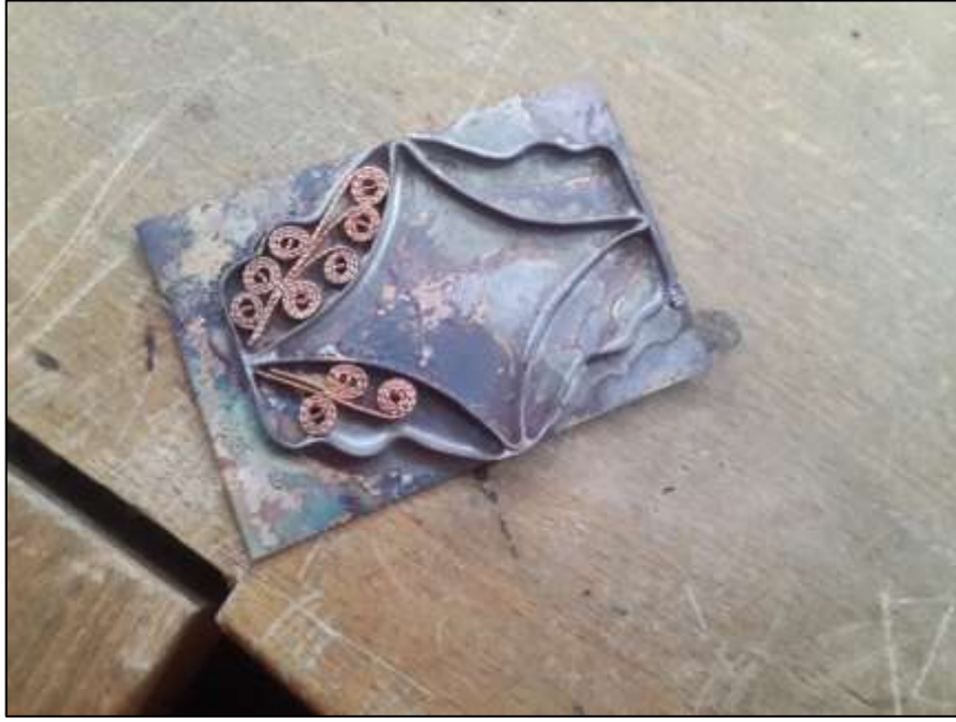
Şekil 298: Astara Kaynatılmış Olan Çatı Aralıklarına Bitkisel Motifli Tellerin Doldurulması
