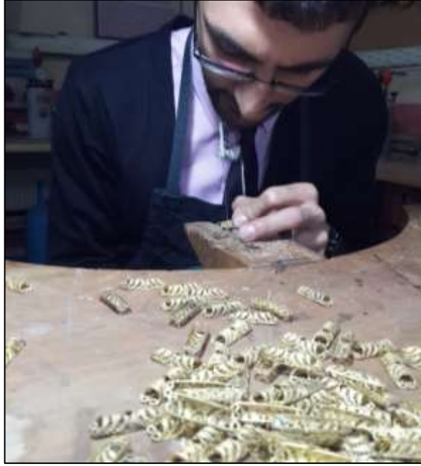
Şekil 310: Dökümden Çıkmış Olan Fişeklerin Kıl Testere Yardımıyla Temizlenme İşlemi
