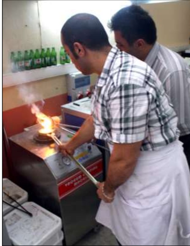
Şekil 89: Kayıp Mum Tekniğiyle Döküm Yapımı
