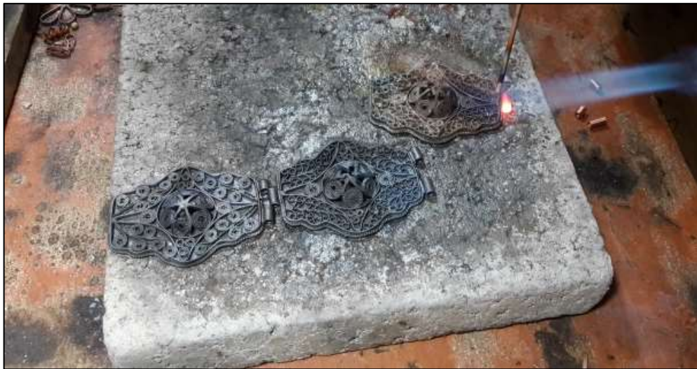
Şekil 301: Paftalar Arasına Menteşe Halkaları Kaynatma İşlemi
