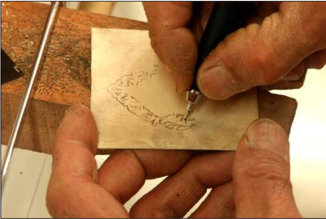
Şekil 112: Gümüş Levha Üzerine Motif Çizimi
