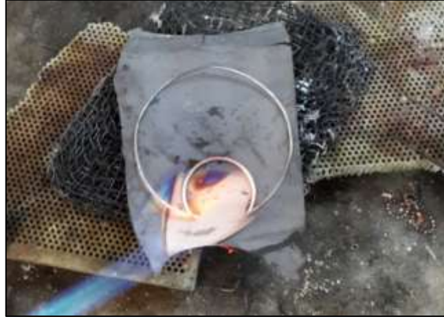
Şekil 315: Hilal Şekli Verilmiş Olan Telin Astaraya Kaynatılması
