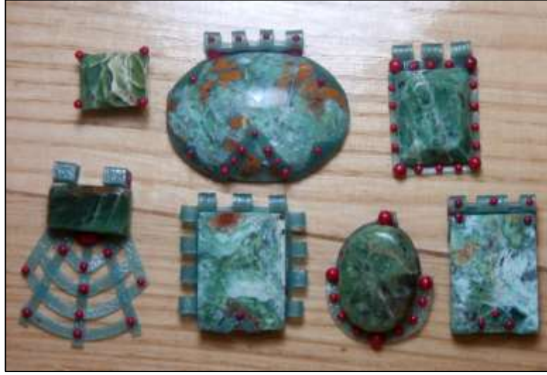
Şekil 330: Modelaj Mumlarıyla İşlenmiş Döküme Hazır Takılar
