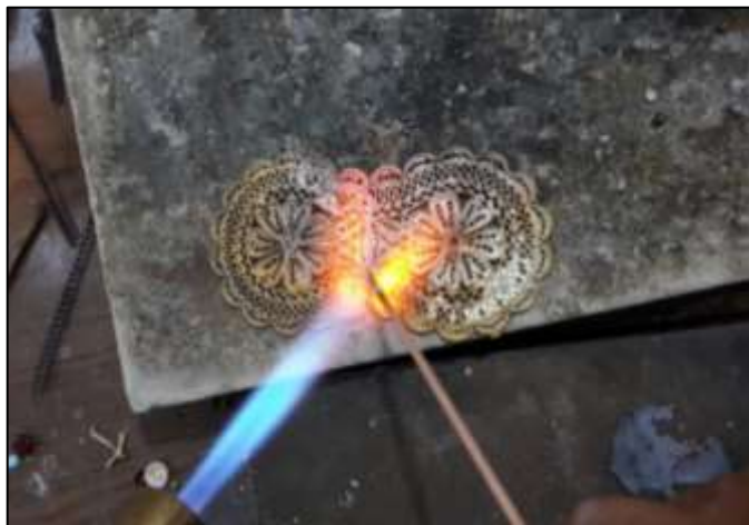
Şekil 311: Dolgu İşlemi Bitmiş Olan Kemer Tokasına Kaynak Yapılırken
