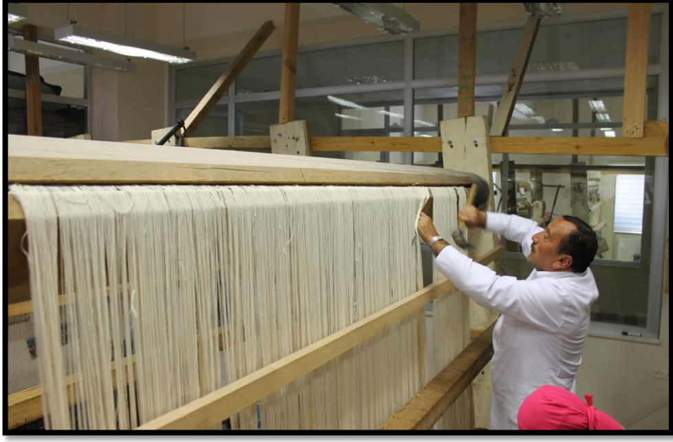
Fotoğraf 29: Çözgü çubuklarını üst levente yerleştirilmesi (Mevlüt Kaplanoğlu)
