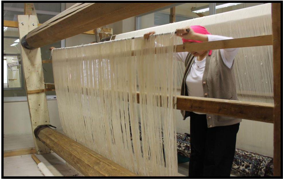
Fotoğraf 28: Çözgü çubuklarını üst levente yerleştirilmesi (Mevlüt Kaplanoğlu)
