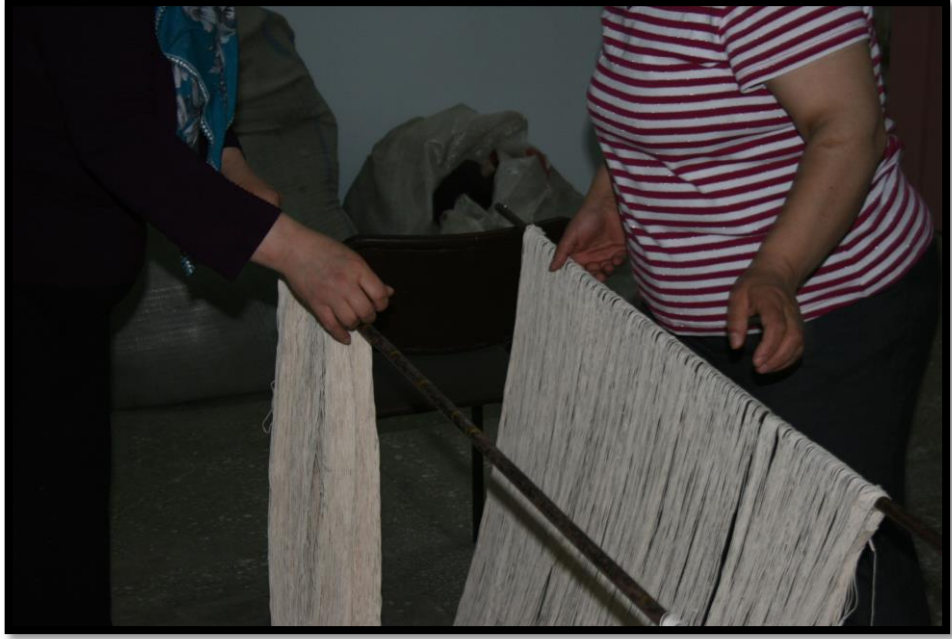
Fotoğraf 26: Çözgü tellerini çubuk demirlere yerleştirme (Mevlüt Kaplanoğlu)
