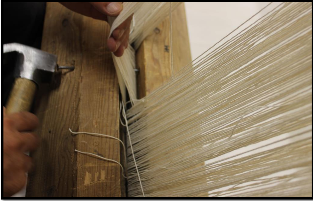
Fotoğraf 30: Çözgü çubuklarını alt levente yerleştirilmesi (Mevlüt Kaplanoğlu)
