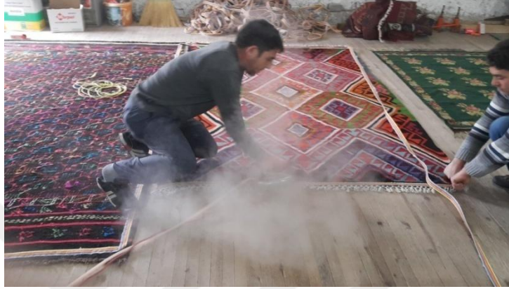
Fotoğraf -108 Tuba Ayhan, Kilimin Ütülenerек Gerdirilmesi, 2018.
