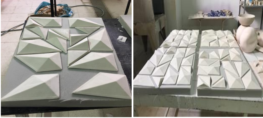
Resim -138 Porselen Modüllerin Kurutulması
