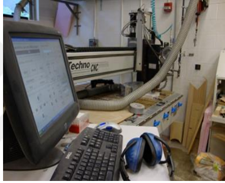
Resim-29 Lithaphone Olarak Tasarlanan Görselin Bilgisayar İle CNC Makinasına Aktarılması
