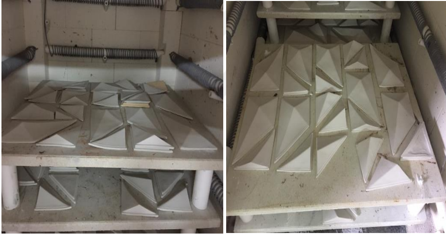
Resim -142 Pişmiş Porselen Modüllerin Fırından Çıkarılması
