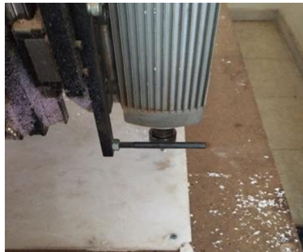
Resim-30 Corian Parçanın CNC Makinasına Ayarlanması
