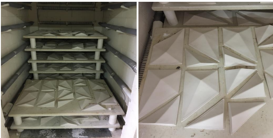
Resim -140 Porselen Modüllerin Pişirilmesi
