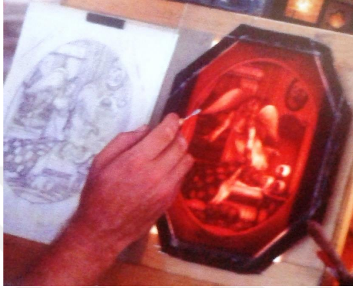
Resim-26 Lithaphone Yapılacak Görselin Işıklı Masada Oyma İşlemi
