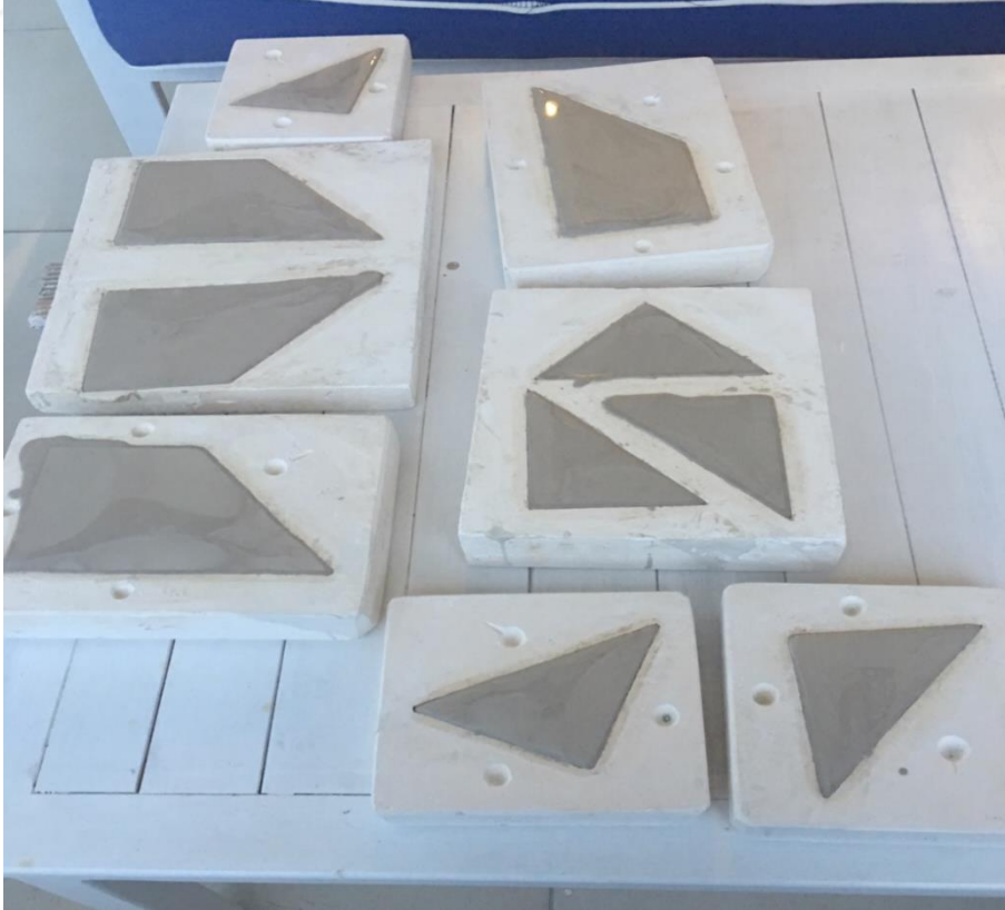
Resim -137 Hazırlanan Alçı Kalıplardan Porselen Modüllerin Alınması
