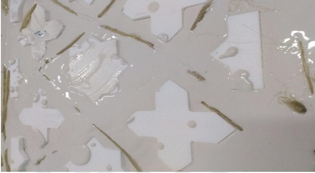
Resim-58: Alçı dökümü ve keten liflerin yerleştirilmesi
