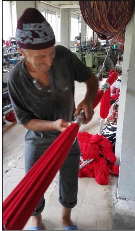
Fotoğraf 1. 70: Çözgü iplerinin bağlanması, Sakaoğlu Keşan El Dokuma Fabrikası, Çarşıbaşı, Trabzon (Menekşe Suzan Teker, 2015)
