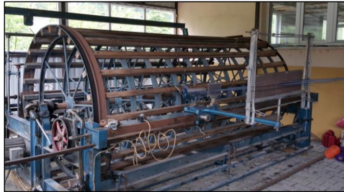
Fotoğraf 1. 72: Gücünden ve taraktan geçirilmiş çözü iplerinin levende aktarılması, Sakaoğlu Keşan El Dokuma Fabrikası, Çarşıbaşı, Trabzon (Menekşe Suzan Teker, 2015)
