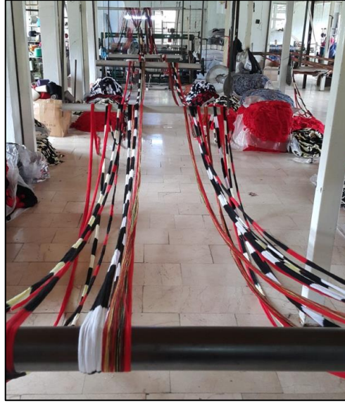
Fotoğraf 1. 71: Boyama sonrasında levende sarılmak üzere bekleyen çözü ipleri, Sakaoğlu Keşan El Dokuma Fabrikası, Çarşıbaşı, Trabzon (Menekşe Suzan Teker, 2015)
