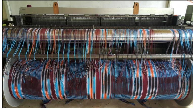
Fotoğraf 1. 74: Dokuma makinasına yerleştirilmiş dört adet şal çözgüsünün bulunduğu levend, Sakaoğlu Keşan El Dokuma Fabrikası, Çarşıbaşı, Trabzon (Menekşe Suzan Teker, 2015)
