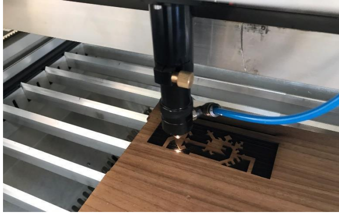
Görsel. 28: Kalıp/ağaç baskının lazer kesim uygulaması (Özcan, 03.06.2020).
